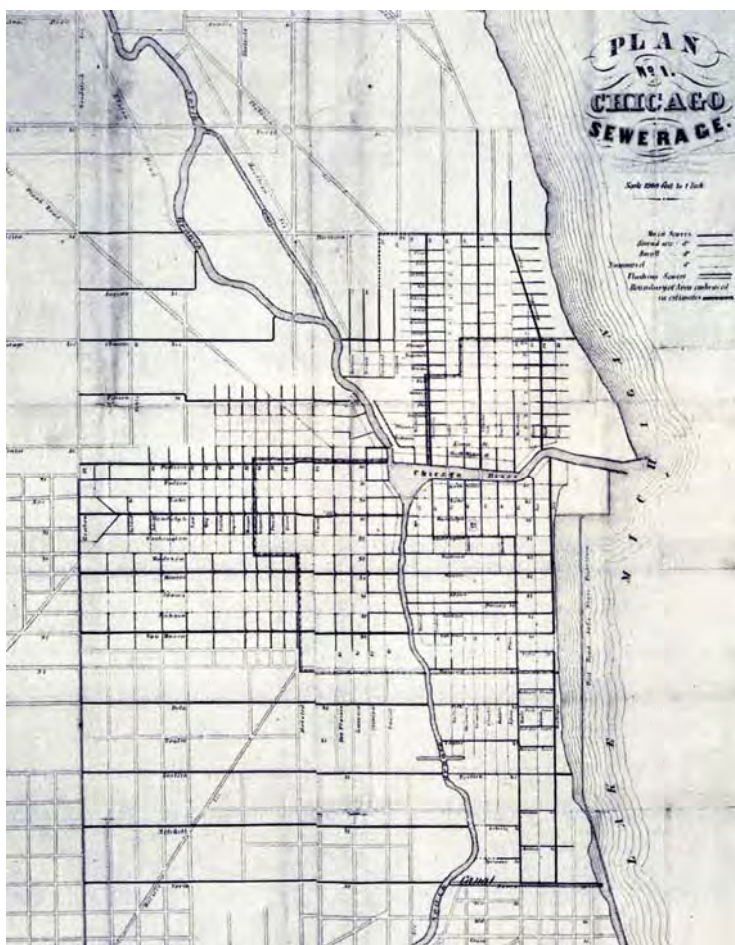
Figura núm. 9-73: Plànol de la xarxa de clavegueram de la ciutat de Chicago (Illinois-Estats Units) 72 . Projecte de l'any 1855, obra de l'enginyer Ellis Sylvester Chesbrough (1813-1886). L'any 1855, Chicago era una ciutat en creixement i tenia molts problemes en el seu subministrament d'aigua i en l'eliminació d'aigües residuals. Després d'una gran epidèmia de disenteria es va encarregar a Ellis Sylvester Chesbrough, dissenyador del sistema de distribució d'aigua de Boston (Estat Units), la resolució del problema de salut pública de la ciutat. Chesbrough, un enginyer autodidacta, va dissenyar i va supervisar la construcció del primer sistema de clavegueram integral de la nació americana, permetent que la ciutat seguís creixent. El sistema planificat per Chesbrough es va basar en el flux per gravetat, però els centres dels carrers eren massa baixos per drenar cap al riu. Les clavegueres es van construir sobre el nivell del sòl existent i després es van cobrir, augmentant el nivell de la ciutat, en segons quins llocs, fins a 10 metres.
