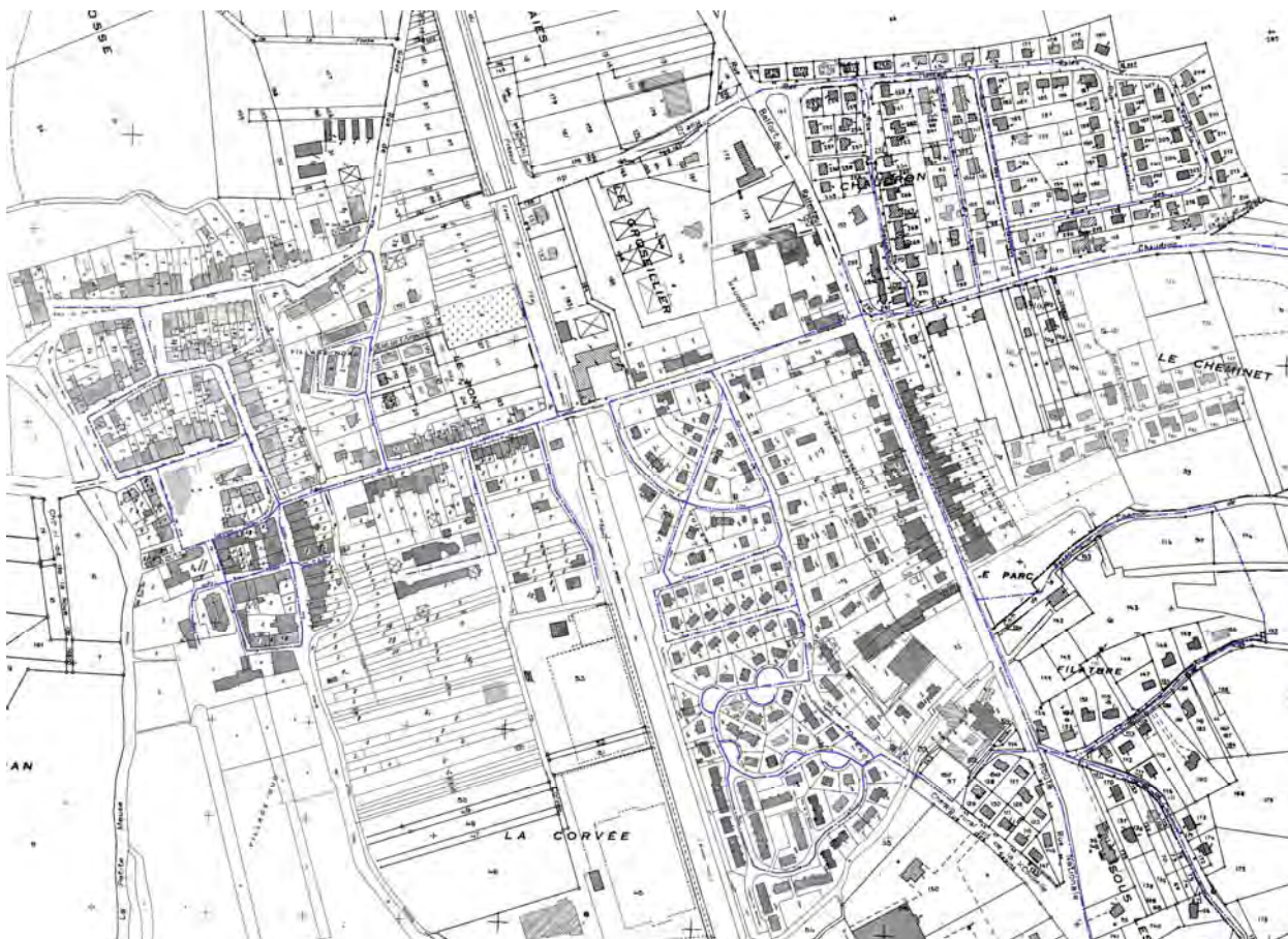
Figura núm. 9-76: Porció del plànol de la xarxa principal d'aigua potable del municipi de "Dieu-sur-Mer" -França- de l'any 2007. La xarxa principal d'aigua potable s'ha dibuixat, en color blau i ratlles de traç i punt, sobre el plànol base que va ser encarregat per procedir a la revisió del "Plan local d'urbanisme". Autors "ESpace & TERRitoires" -consultors d'urbanisme-.
