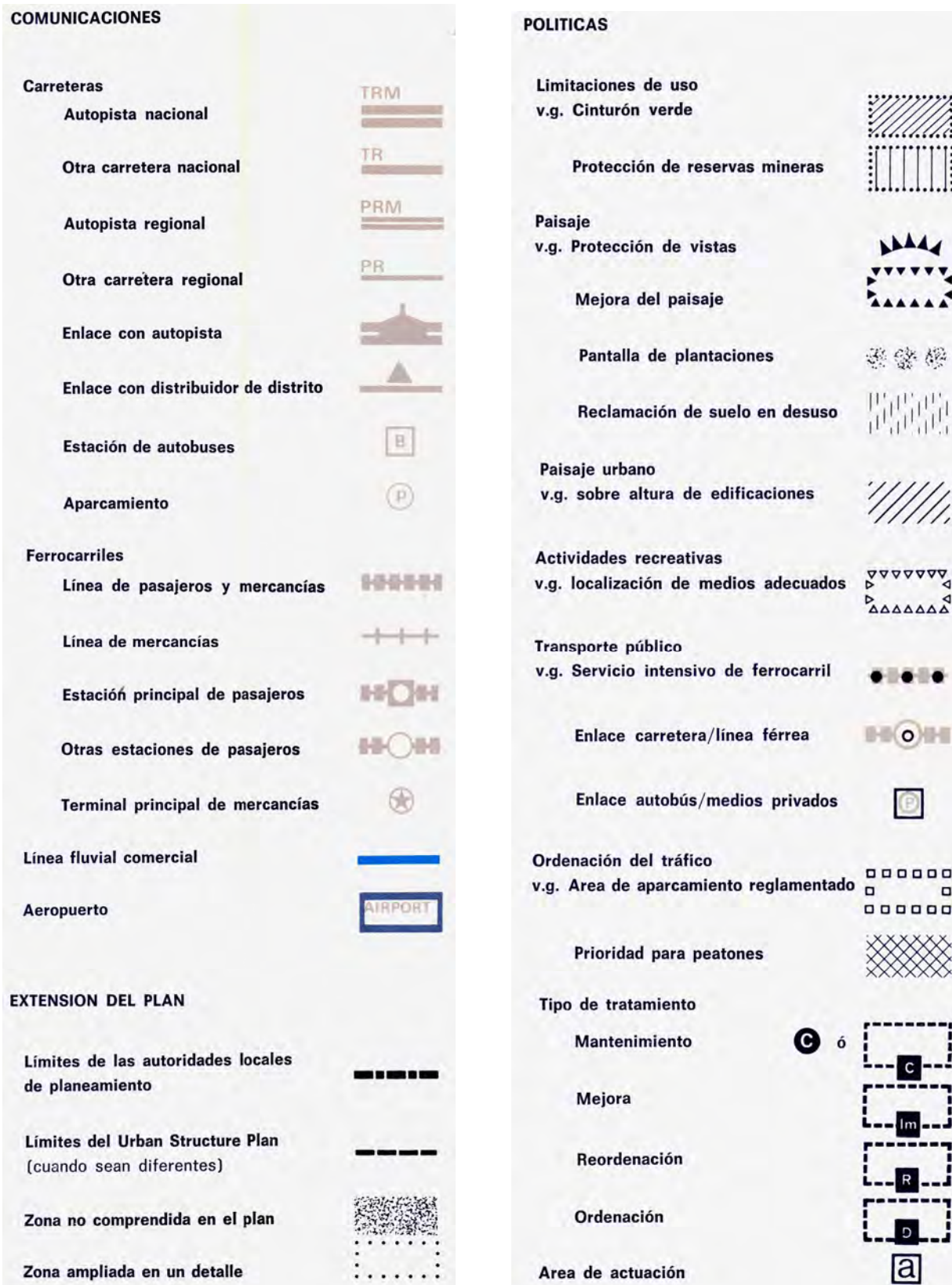
Figura núm. 6-27: Simbologia sobre Comunicacions, Extensió del Pla i Politiques presentat en el document "Ministry of Housing and Local Government" - Londres, 1970-. Plans d'ordenació urbana: Manual sobre la seva forma i contingut 34 .
