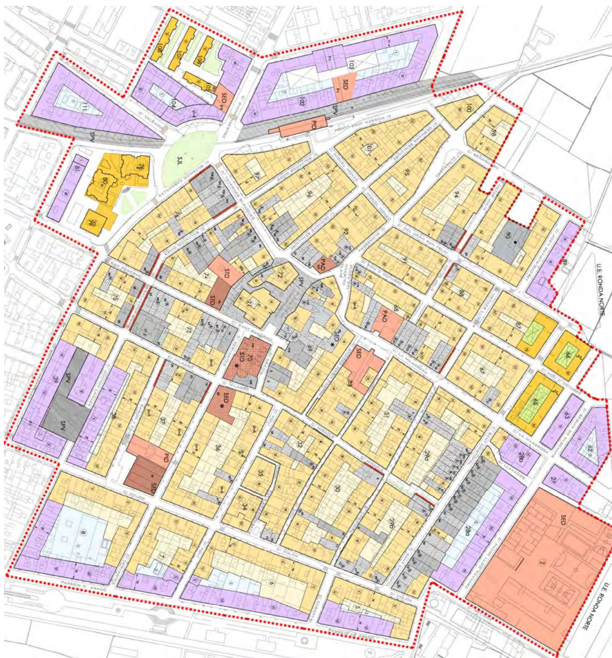
Figura núm. 9-57: Pla de reforma interior del centre històric d'Alboraya (València) 56 . En aquest cas al grafiat convencional de les illes del casc d'una ciutat s'hi sobreposa el color o les trames de ratllat geomètric, per tal de categoritzar les diferents zones o certes edificacions en particular.
