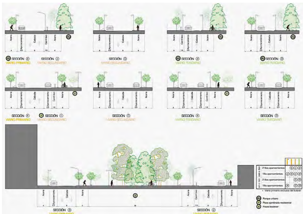
Figura núm. 9-86: Plànol a escala 1:200 dels esquemes de les seccions del viari del Plan Parcial Sector Sur R9 "La Isla", Alcalá de Guadaíra, Sevilla -Espanya-, de l'any 2008. Obra de Francisco José Pastó de la Poza, Julia Rodríguez Miranda, Gabriel Morales Manchón i Rafael Pérez Chamizo -Arquitectes 84 .
