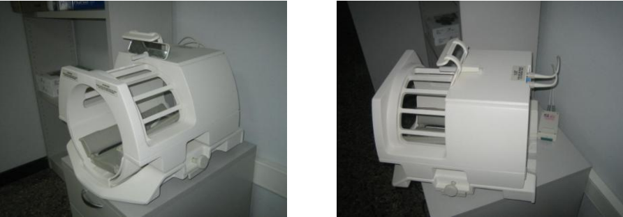
Figura 15. Bobina de cabeza de un canal empleada para el estudio espectroscópico, vista en dos proyecciones.
