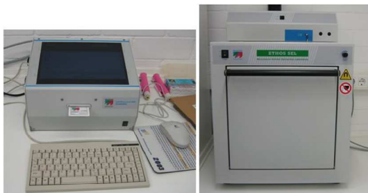
Figura 3.13. Fotografía del digestor de microondas utilizado en la digestión ácida de las muestras.
