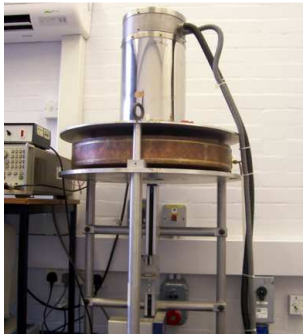
Figura 3.14. Fotografía de la cavidad de perturbación usada para las mediciones de las propiedades dieléctricas.
