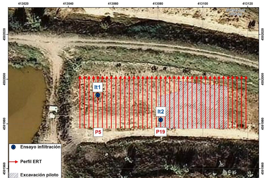
Figura 4.60. Ortofotografía (ICGC 2016) con la ubicación de los ensayos de infiltración y de la excavación piloto en la balsa de infiltración de Ca n'Albareda
