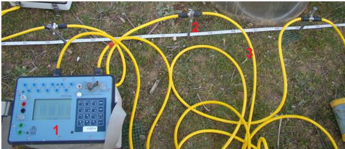
Figura 3.11. Fotografía del equipo de tomografía eléctrica SYSCAL PRO con el que se ha realizado la adquisición de datos geoelectrónicos en la Cubeta de Abrera y en la Vall Baixa del Llobregat. Dónde: 1- Unidad central, 2- Electrodo, 3- Cables de conexión SYSCAL PRO-electrodos. Fotografía realizada Gal·la Serra [5 de marzo de 2012]
