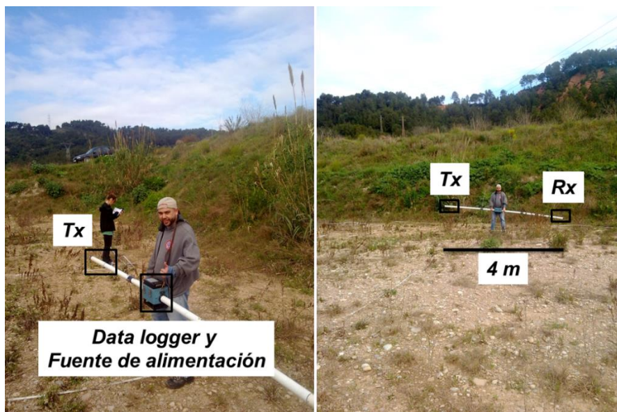
Figura 3.2. Instrumento Geonics EM-31 durante la adquisición descrita en el apartado 4.5
