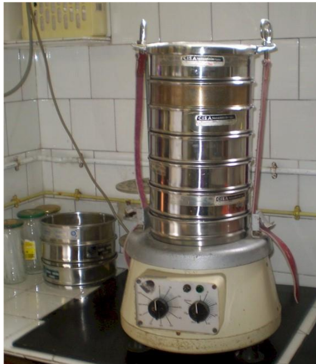
Figura 3.16. Batería de tamices usada para obtener las curvas granulométricas. Fotografía de R. Lovera
