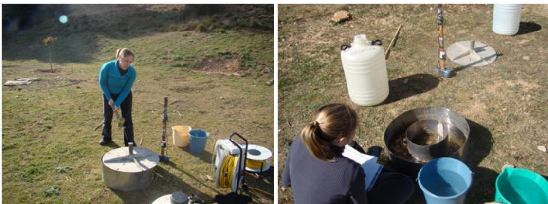
Figura 3.19. Fotografía del infiltrómetro de doble anillo durante la realización de los ensayos de infiltración. A la izquierda proceso de inca de los dos cilindros al terreno, a la derecha obtención de medidas. Fotografías realizadas el 5 de marzo de 2012
