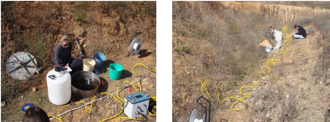
Figura 4.36. Fotografía del ensayo de infiltración con el infiltrómetro de doble anillo (izquierda) y del perfil ERT (derecha) realizados en el punto 1. Fotografías realizadas el 5 de marzo de 2012
