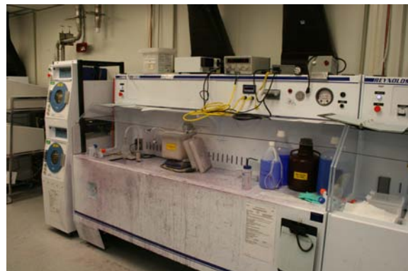
(d) Electroplating Hood
