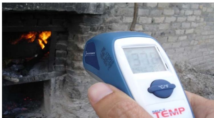
Figura 59. Medições mínimas e máximas da temperatura do forno de processamento de raiz, queimando espécies de lenha da floresta nativa.
