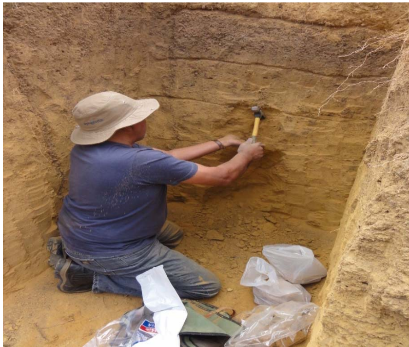
Figura 45. Exemplo do trabalho de campo para coleta de amostras do perfil de solo e encaminhamento das mesmas para análises físico-químicas.
