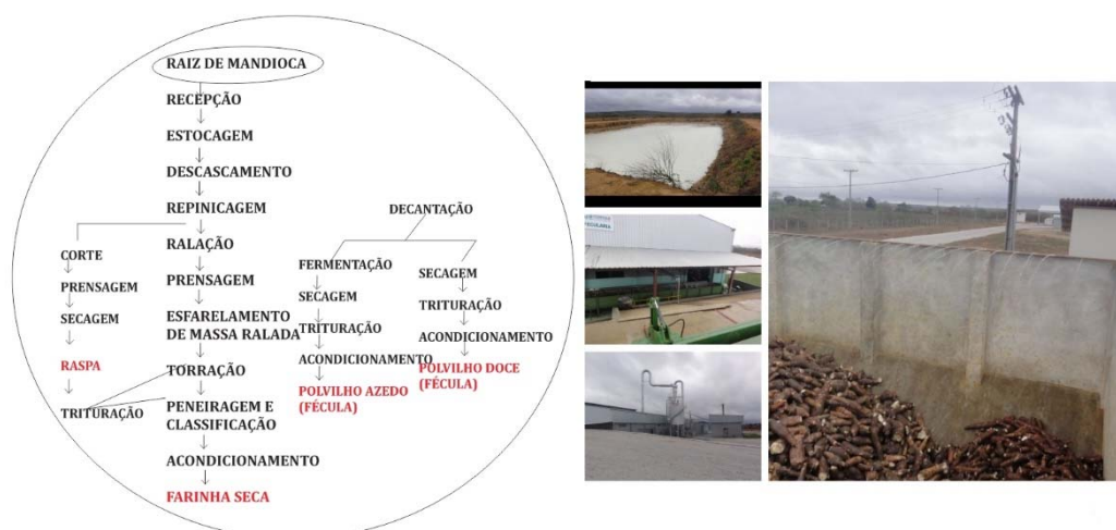
Figura 154. Fluxograma de produção de fécula, farinhas e raspas a partir da raiz de mandioca e imagens da fecularia da Coopasub.
