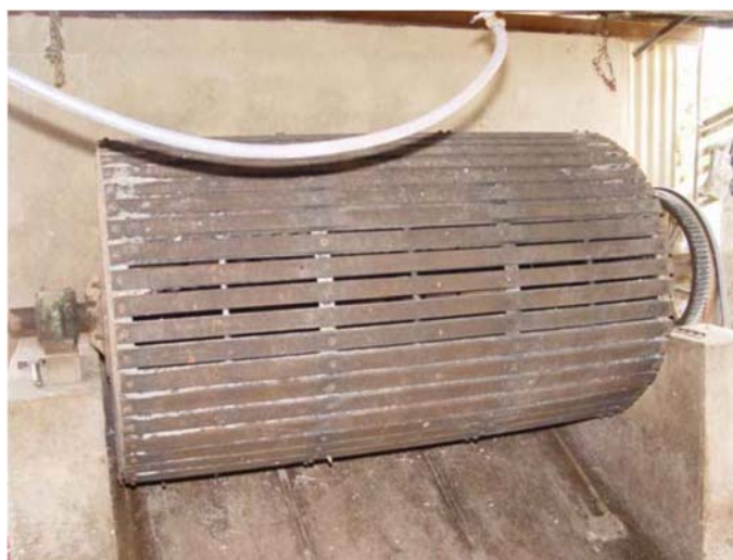
Figura 149. Equipamento de lavagem e descasque da raiz de mandioca
