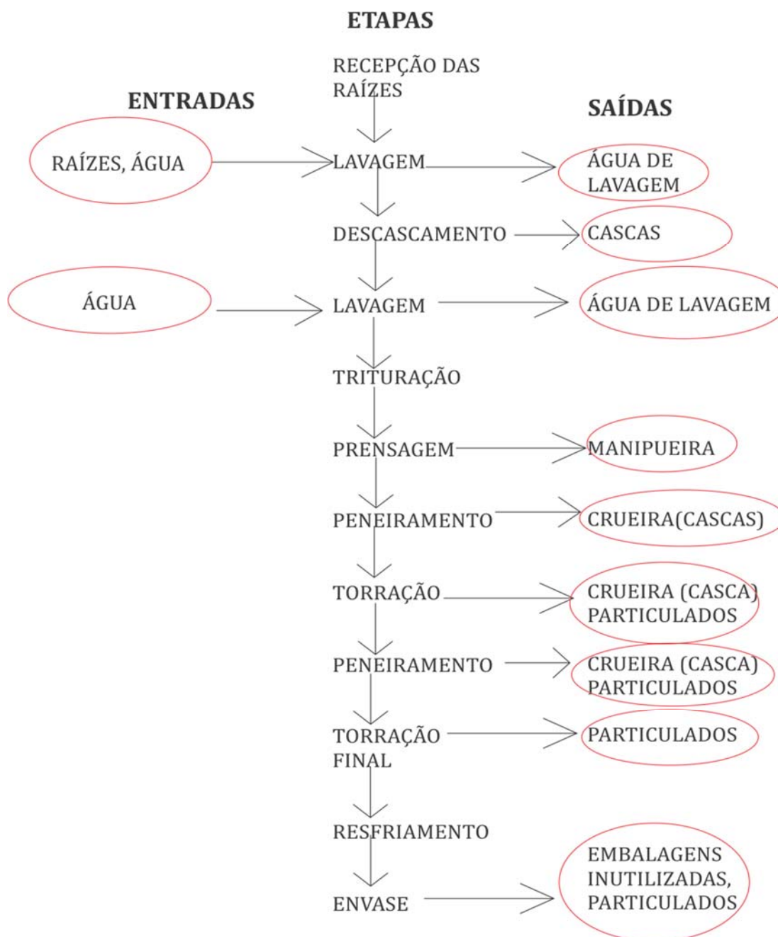
Figura 148. Fluxograma de processo de beneficiamento de raízes com descrição das etapas, entradas e saídas.
