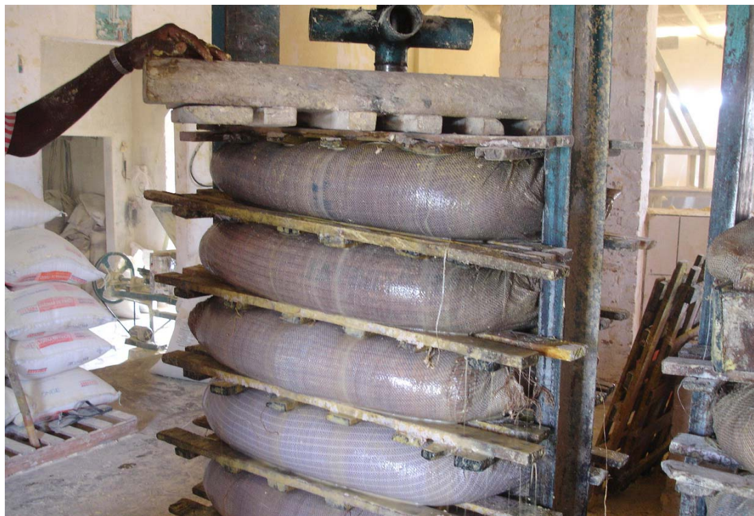
Figura 103 - Prensagem da massa ralada e obtenção de manipueira numa casa de farinha. Lagoa Grande, vila de Cândido Sales-Ba.
