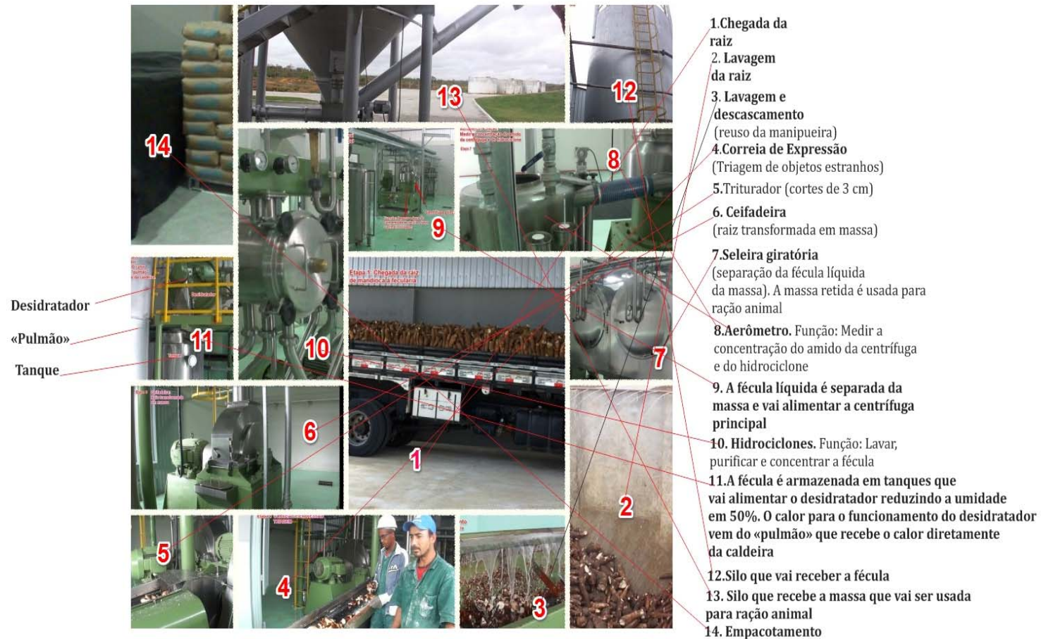
Figura 155. Etapas para a processamento de obtenção de fécula a partir da raiz de mandioca, no distrito do Corta-Lote.
