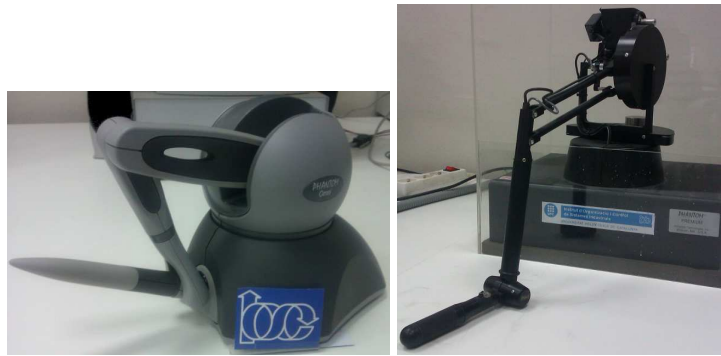
Figura 6.4: Dispositivos hápticos Omni y Premium. Físicamente no existen diferencias entre la versión normal y la highforce del modelo Premium.
