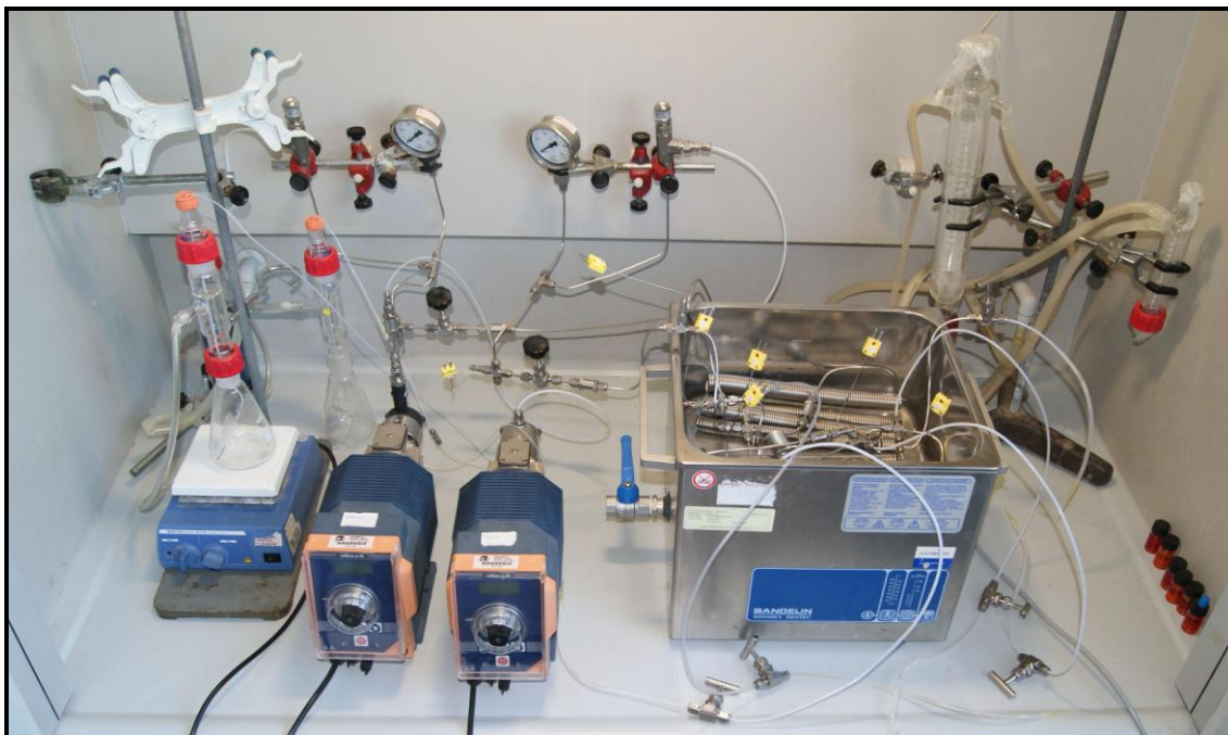
Figura 36. Fotografía del montaje experimental completo: líneas de alimentación y reactor helicoidal sumergido en baño termostático y de ultrasonidos.
