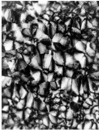
Figura 35. Estructura esferulítica bajo luz polarizada.
