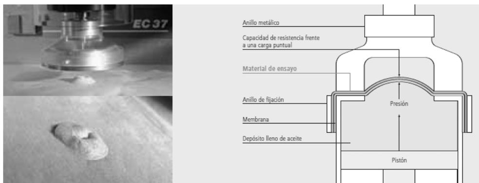
Figura 118. Ensayo de resistencia al reventamiento
