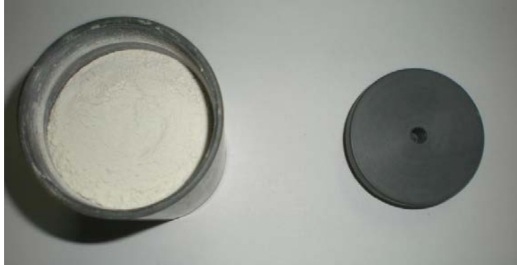
Figura 101. A la derecha: Portamuestras con relleno de muestra de parafina. A la izquierda: Tapadera del portamuestras con mecanizado para la barra metálica.
