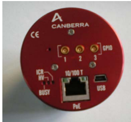
Figura 81. Vista en planta del multicanal Osprey. A la derecha: conexión USB.
