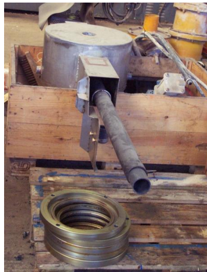
Figura 96. Estructura del prototipo manual en el proceso de inserción del nuevo guía del portamuestras (sección circular).
