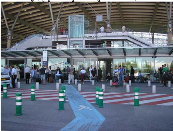
Fig. 8.10. Espacio reservado para el taxi (rayas blanco-rojo) y para el peatón (pasillo azul)
