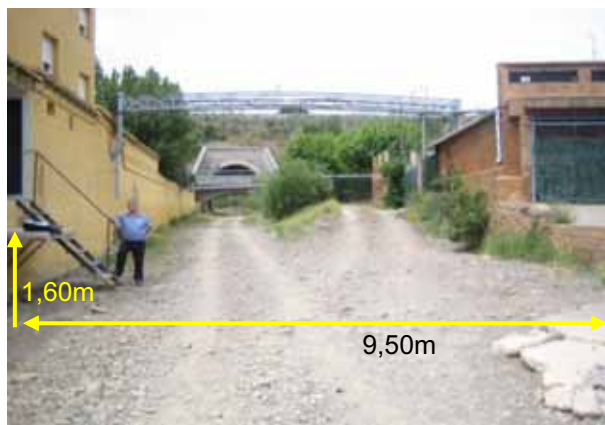
Foto G5.- Secció G3 de la llera reduïda (uns 16 m 2 ) per les construccions, a l'àrea urbanitzada de la desembocadura. L'alçada de l'escarpament de la terrassa T 0 coincideix amb el nivell de la porta de la cuina del càmping situada a l'extrem de la fletxa vertical de l'esquerra de la foto (riba dreta del torrent). (foto PMR, maig 2009)
