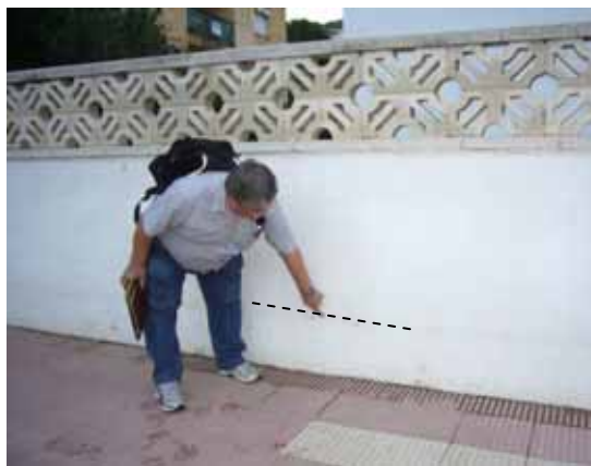
Foto S45.- Nivell assolit per l'aigua en el carrer de la Selva (45 cm sobre la vorera), la matinada del 13 d'octubre 2010. (foto MAM)
