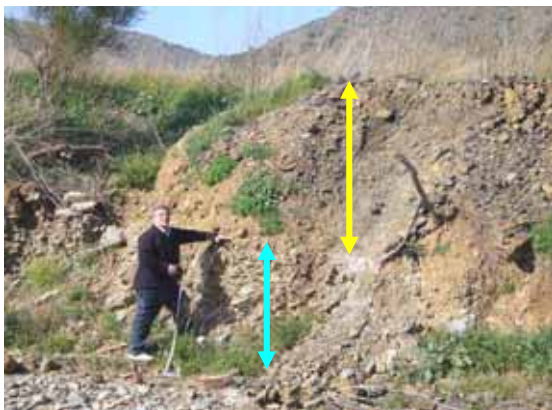
Foto S17.- Sector a la riba dreta, proper a les Cavorques. Capa inferior terrassa T_1 i capa superior terres d'abocament. (Foto M.A.M. març 2009)
