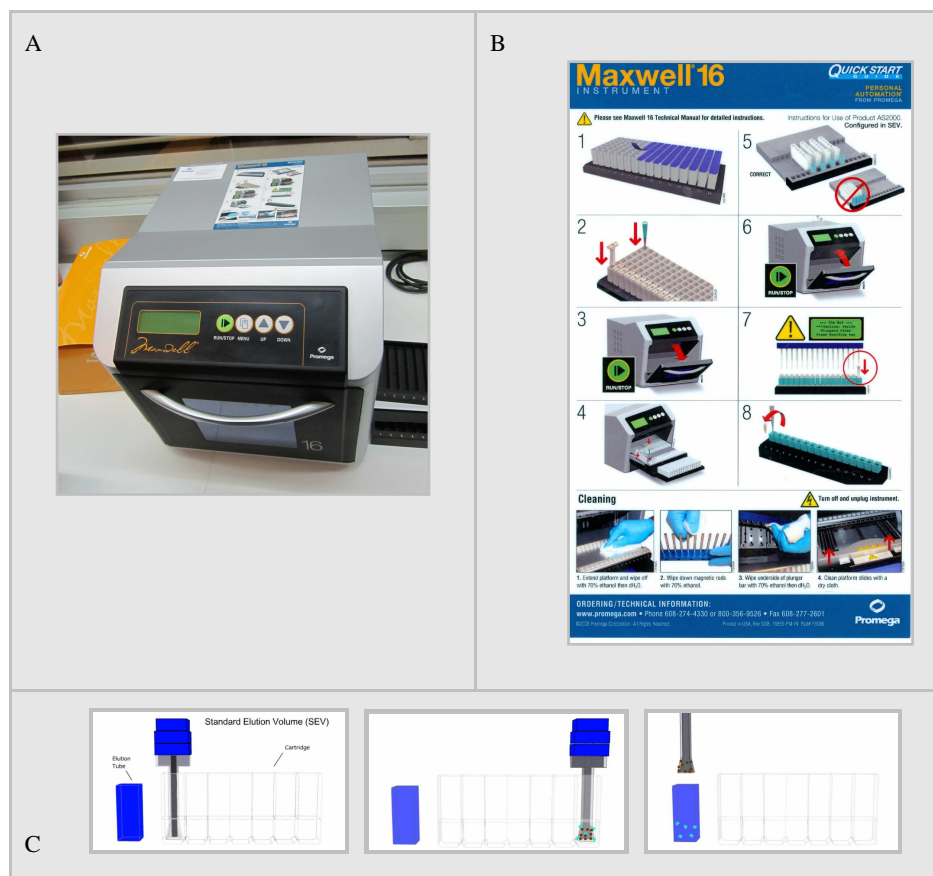
Figura 12. A. Maxwell 16 System. B. Guía de utilización del Maxwell 16. C Esquema detalle de la extracción de ADN.
