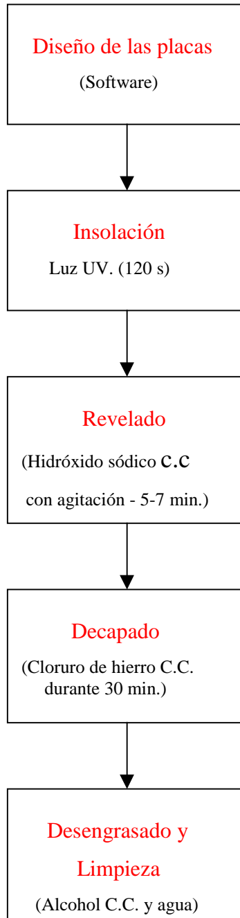
Fig. 3.2.3 Proceso para la obtención de los transductores de los electrodos en placas en fibra de vidrio mediante la técnica de circuitos impresos.
