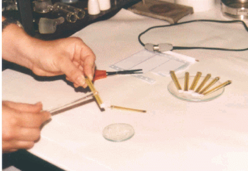
Fig. 3.2.4 Encapsulamiento de los electrodos de configuración plana con resina epoxy (mezcla de Araldit y endurecedor).
