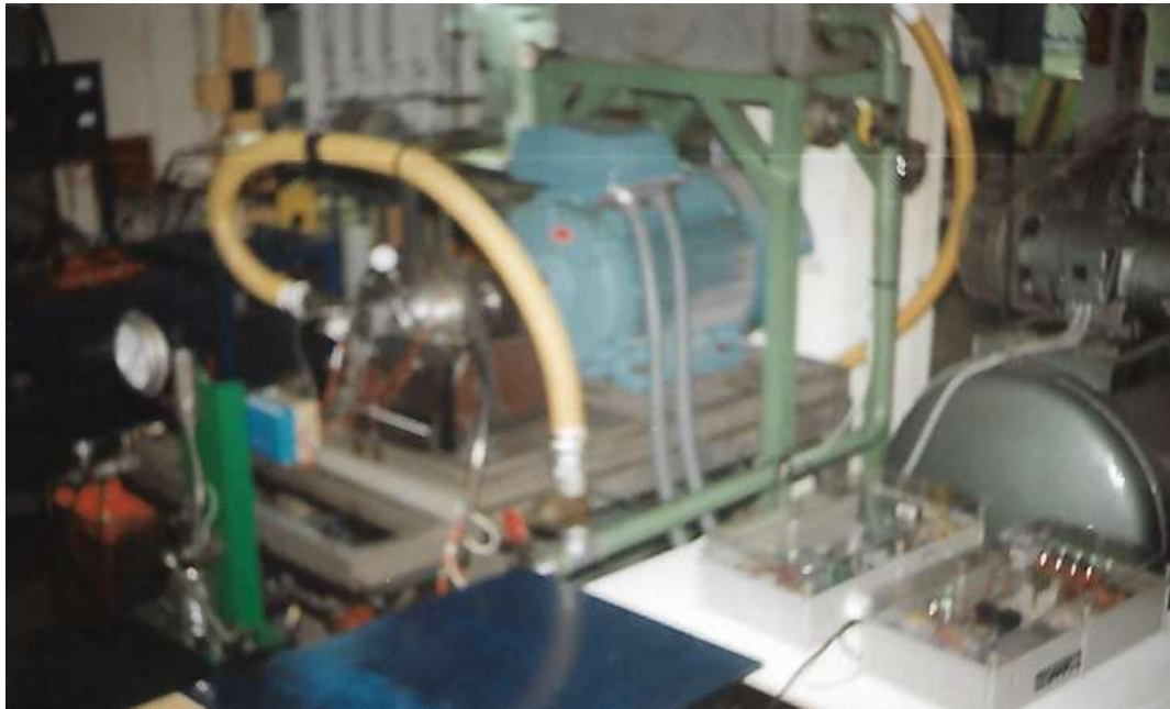
Figura 4-1: Muntatge experimental ISO 8426:1988 i ISO 4409:1986
