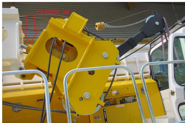
Figura 8-22: Moviment del JIB
