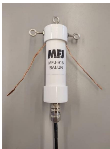
Figura 18. Balun integrado en la plataforma NVIS para adaptar la salida del amplificador con la antena
