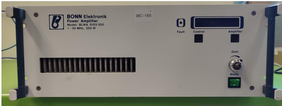
Figura 10. Amplificador BONN modelo BLWA 0103-250 integrado en la plataforma transmisora de sondeo NVIS
