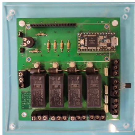
Figura 7. Plataforma Teensy integrada en la plataforma transmisora de sondeo NVIS para llevar a cabo el control del amplificador
