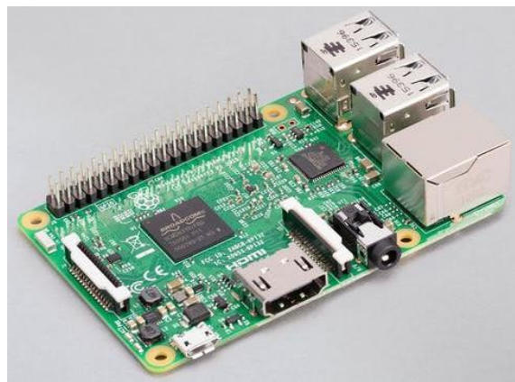
Figura 6. Plataforma Raspberry Pi 3 [71] integrada en la plataforma de sondeo NVIS para llevar a cabo el control principal de esta
