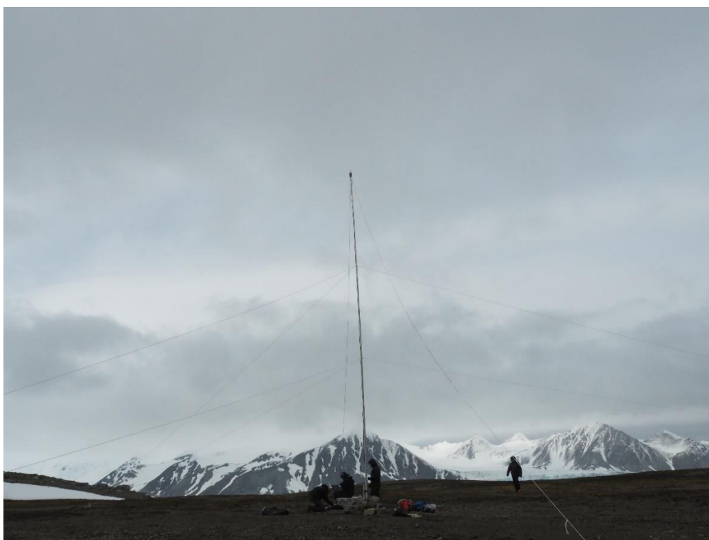
Figura 20. Antena V invertida en Glaciar Rocoso (isla de Livingston, Archipiélago Shetland South, Antártida)
