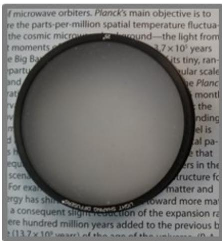
Figura 4.18: Difusor holográfico empleado en el experimento de imagen holográfica a través de un medio turbio. No es posible observar un objeto a través del difusor con métodos convencionales.
