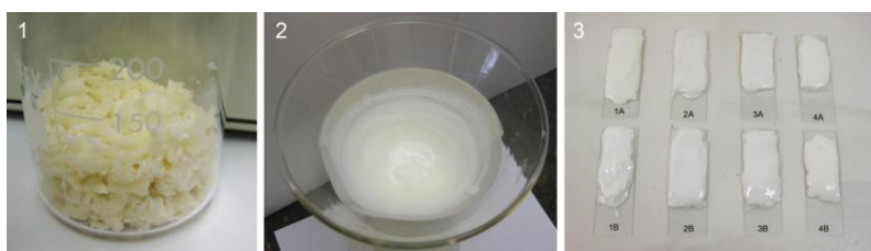
Figura 2.6. Caseïnes obtingudes a partir de formatge (1) i de llet (2) utilitzades per l'elaboració de patrons de caseïnats de calci (3)
