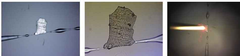
Figura 2.12. Imatges de microscòpia de la preparació de la mostra sobre una finestra de ZnS per ser analitzada amb SR-RE-AFMIR. Es tracta d'una secció transversal de caseïnat de calci de proporció caseïna: \text{Ca}(\text{OH})_2 2:1 de 500 nm de gruix.
