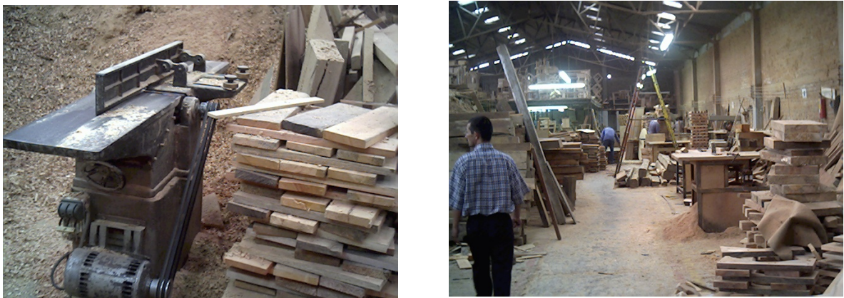
Fig. 5.4 Fotografía del área de corte. Se observa un cúmulo de serrín y materia prima en forma desordenada obstaculizando vías peatonales y áreas de manipulación de las herramientas de trabajo, incumpliendo la norma que se refiere a la distancia entre máquinas, aparatos, equipos, para que el trabajador pueda realizar su labor sin dificultad o incomodidad, evitando los posibles accidentes por falta de espacio entre maquinas no debe ser menor de 0.80 m. Igualmente en lo establecido en orden y aseo (Resolución 2400/79).
