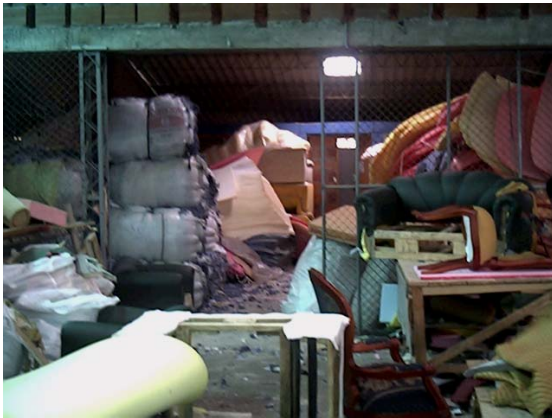
Fig. 5.6 Fotografía del área de tapizado de los muebles y lijadora de banda. Se observa desorden, polvo con el agravante de generar un incendio y/o explosión. Se detectó un número insuficiente de extintores apropiados para el material combustible del área de trabajo, según la norma de seguridad industrial (Resolución 2400/79)
