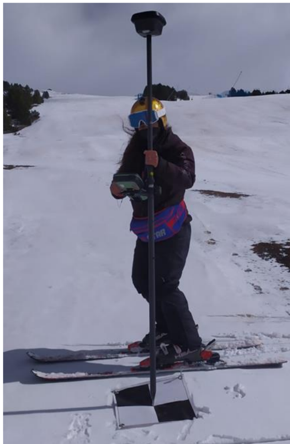
Figura 49. Captura de la posición de un punto de control mediante un rover GNSS Leica GS18 T RTK.
