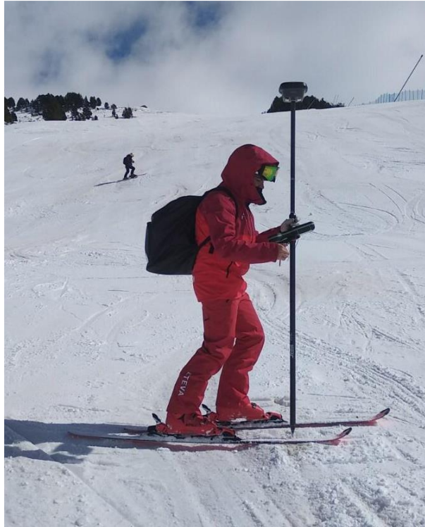
Figura 38. Medición de la posición de una puerta del trazado con el dGNSS high-end en situación estática por Dani Gavaldà Castet
