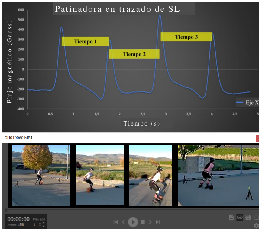
Figura 31. Registro del magnetómetro correspondiente a las cuatro puertas. Se representa el flujo magnético del eje x (vertical). Los recuadros amarillos muestran el tiempo transcurrido entre picos calculado automáticamente con el programa SPRO. Las imágenes estaban sincronizadas con el dispositivo IMU y corresponden al momento en que el patinador pasaba por cada una de las puertas analizadas.
