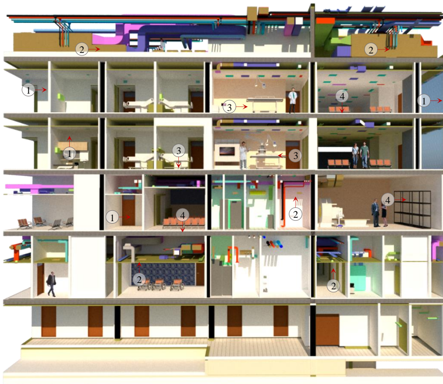
Figura 1-2. Representación conceptual de los componentes y sistemas no estructurales
