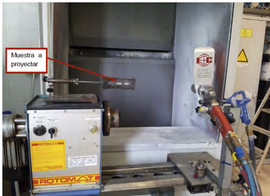
Figura 3.23. Instalaciones para la proyección térmica de oxifuel de la Universidad Jaume I de Castellón.
