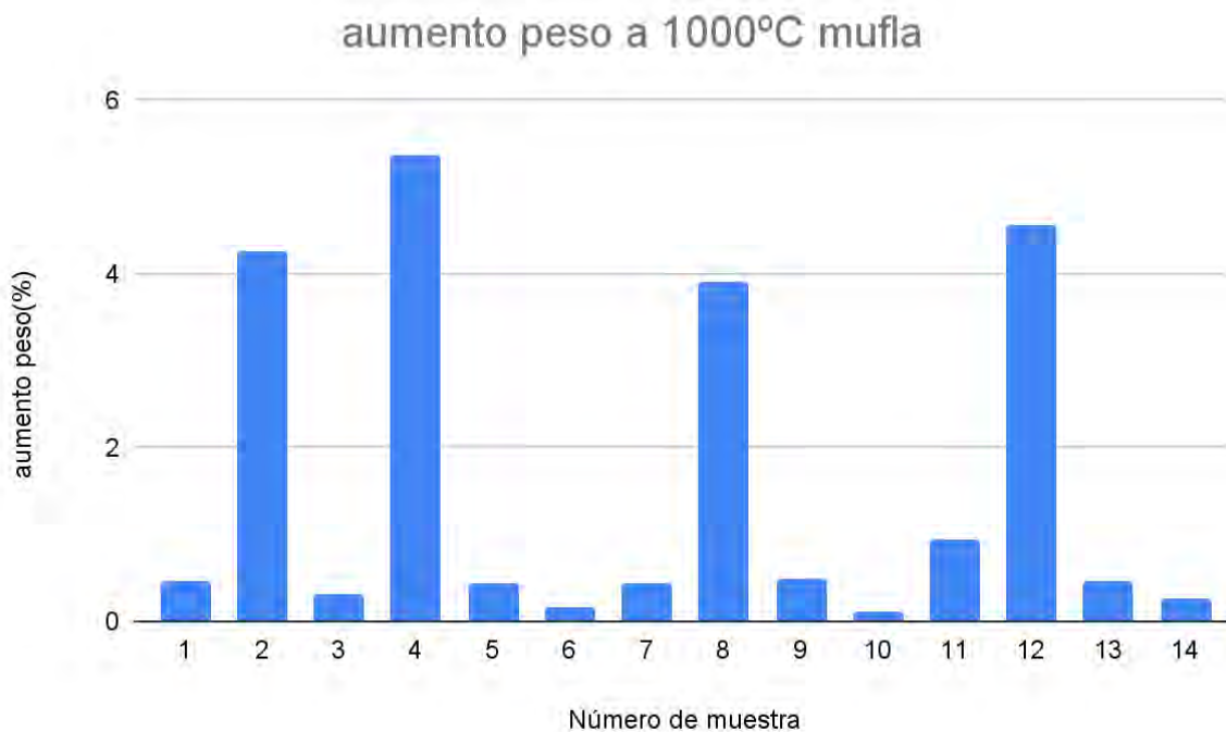
Figura 4.12. Gráfica de aumento de peso de las muestras a 1000°C durante 100 horas en mufla
