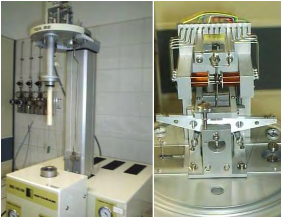
Figura 3.39. (a) montaje de la muestra para la realización del ensayo de oxidación a alta temperatura y (b) detalle de su balanza
