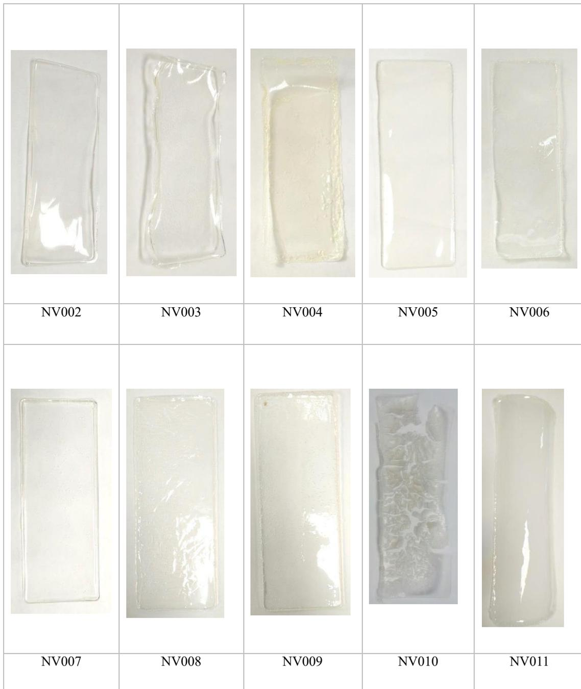
*Figura 12: Films formados a partir de las resinas poliuretánicas*
