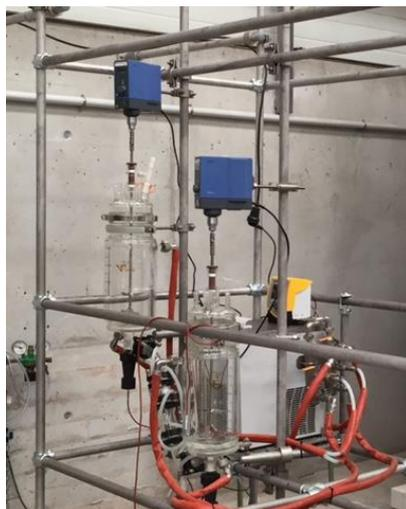
*Figura 10: Reactores para la síntesis de resinas de tipo poliuretano a escala piloto. Reactor 1: Formación del prepolímero (Izq.). Reactor 2 - Alargamiento de la cadena y dispersión acuosa (Der.)*
