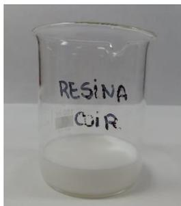
*Figura 11: Muestra de resina de tipo poliuretano*
