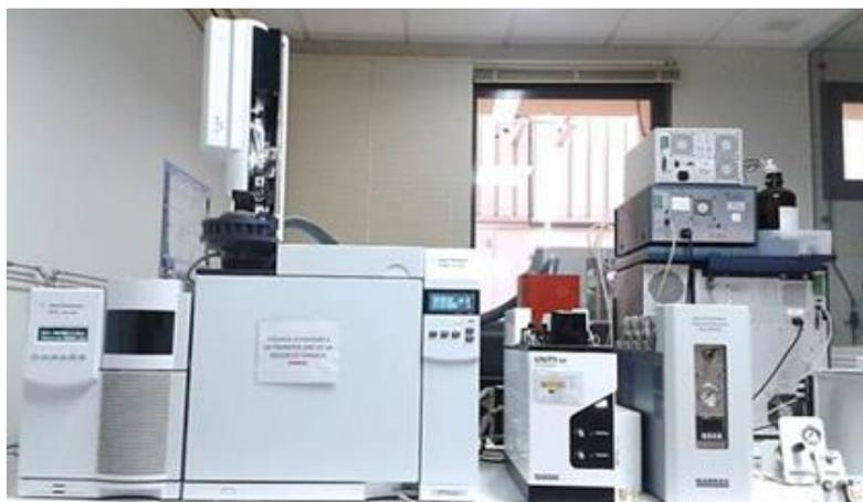
*Figura 28: Cromatógrafo de Gases (Iqz.) y Equipo de Desorción Térmica (Dch.)*
