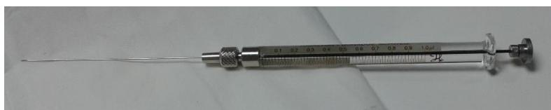
*Figura 34: Jeringa para el calibrado de patrones de 1  $\mu$ L*
