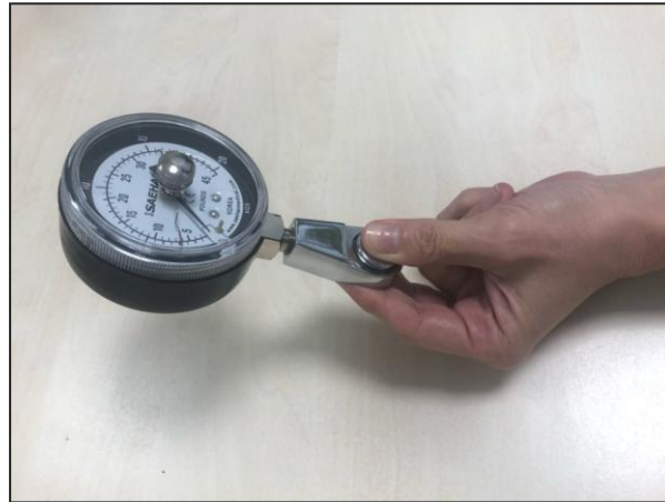
Figura 69. Presa utilizada para la medición de la dinamometría de pellizco palmar digital (o pellizco en trípode).
