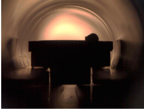
Figura 4-27. Imagen de la gota de aluminio al empezar a fundirse dentro del prototipo 2
