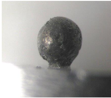
Figura 4-25. Gota de aluminio formada pero que no ha evolucionado sobre acero
