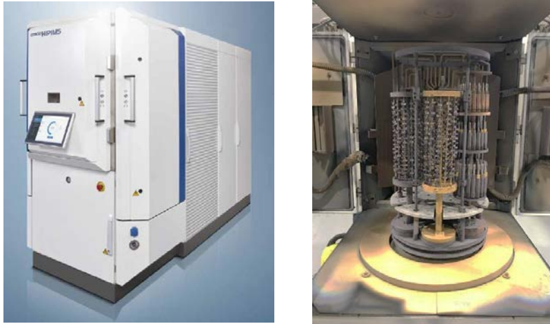
Figura 3-4. Máquina CemeCon CC800/9 ML HiPIMS. Exterior (izq.) e interior de la cámara de reacción (der.)
