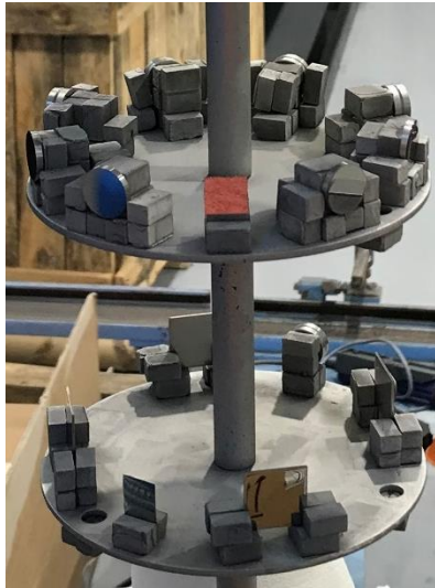
Figura 3-6. Probetas de acero soportadas mediante imanes dentro de la cámara PVD
