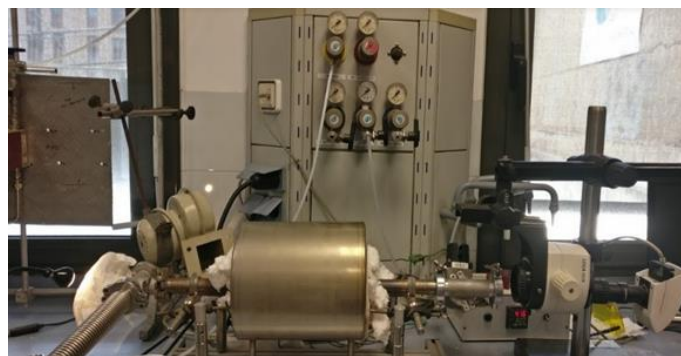
Figura 3-15. Imagen del reactor de mojabilidad
