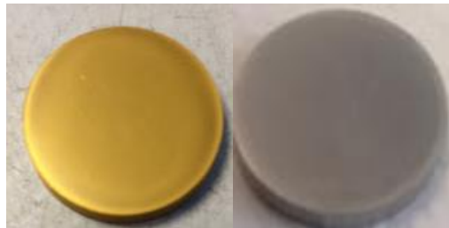
Figura 3-9. Discos de H13 recubiertos por PVD TiN y TaN respectivamente
