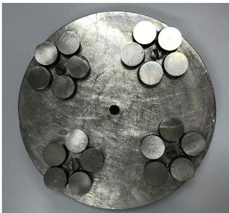
Figura 3-2. Portamuestras para el pulido simultáneo de 20 probetas
