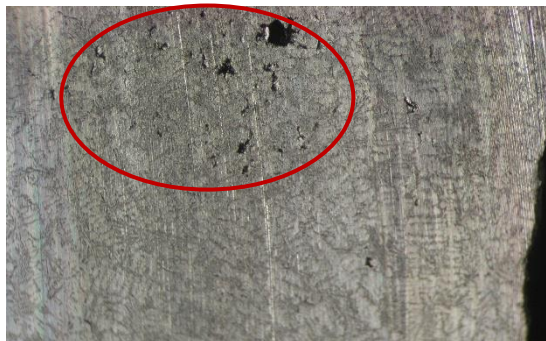
Figura 4-26. Sección transversal del lingote donde se observa la presencia de porosidad.
