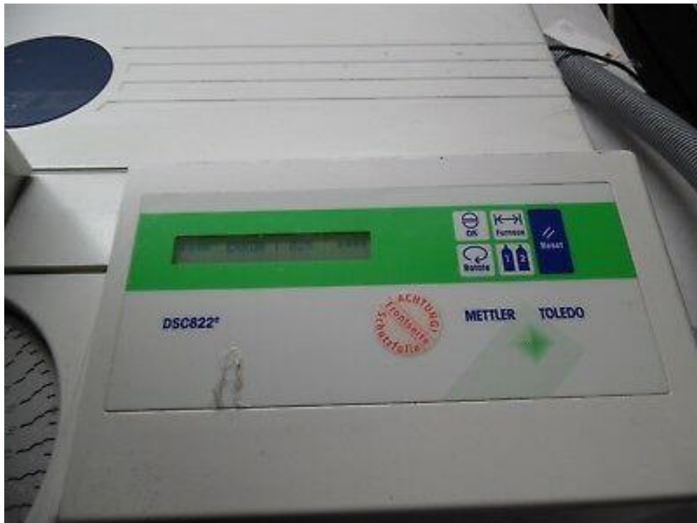
Fig. 4.6.- Calorímetre Mettler Toledo model DSC 822e.
