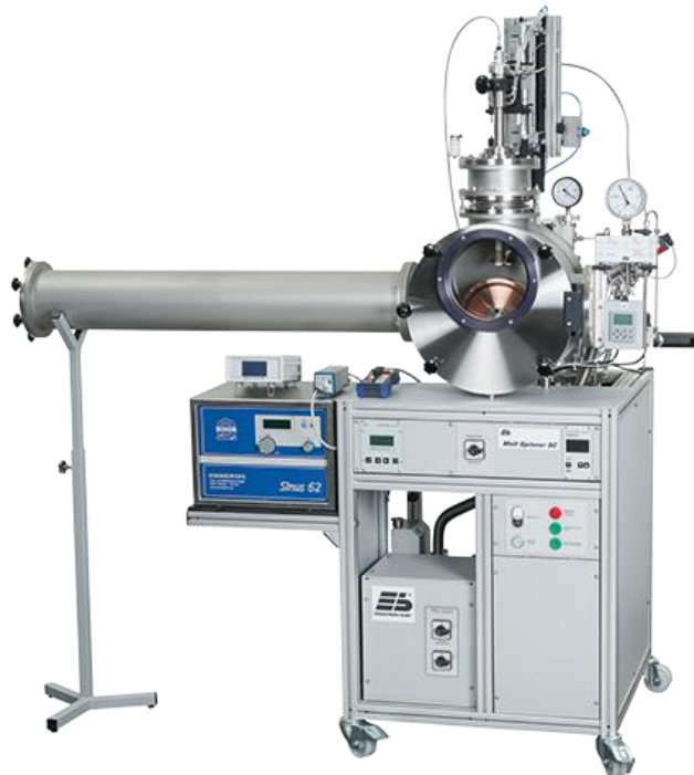
Fig. 4.3.- Imatge del «Melt Spinner SC» de la casa Edmund Bühler.
