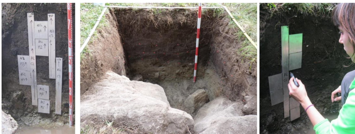
Figura 5.14. Metodología sistemática de muestreo, aplicada a los sondeos paleosedimentarios. El muestreo de sedimentos, en algunos casos, incluye la toma de muestras del perfil mediante molduras de aluminio, para la extracción de láminas delgadas o la toma de muestras en condiciones de laboratorio de las columnas de sedimentos lacustres o aluviales. En la imagen se puede observar la toma de muestras del perfil AS 2, realizada en agosto de 2014 en el Forcall de Sant Esperit.
