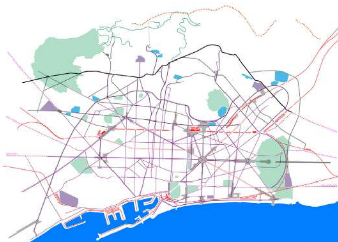
Dibuix de l'autor sobre el Plano de los tranvías y ferrocarriles. Línies en color lila, xarxa de tramvia urbà, magenta discontinu tramvia "interurbà, vermell, xarxa ferroviària, negre i gris, xarxa bàsica viària, places i bulevards.
