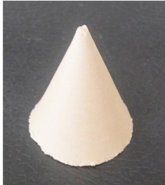
Figura 50 . Conos de fusión de feldespatos de origen Colombiano
