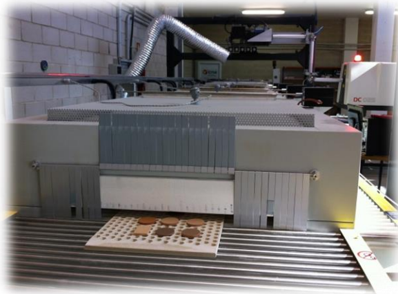
Figura 89. Probetas saliendo de cocción con aplicación de tecnología láser.
