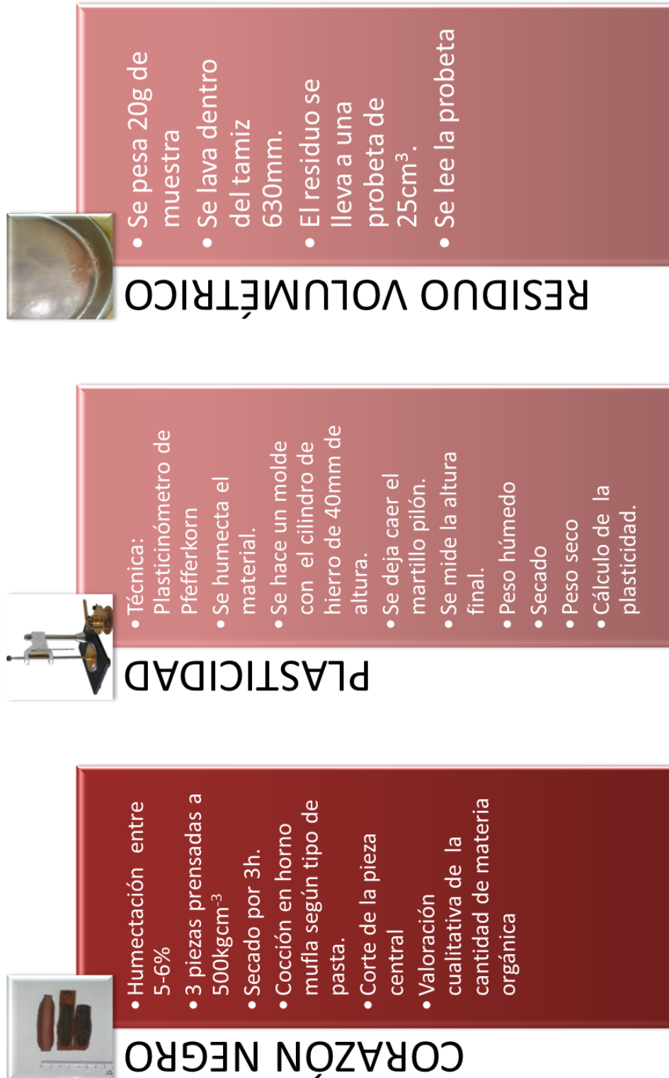
Figura 14. Descripción proceso de caracterización técnica (calcimetría, plasticidad, residuos)
