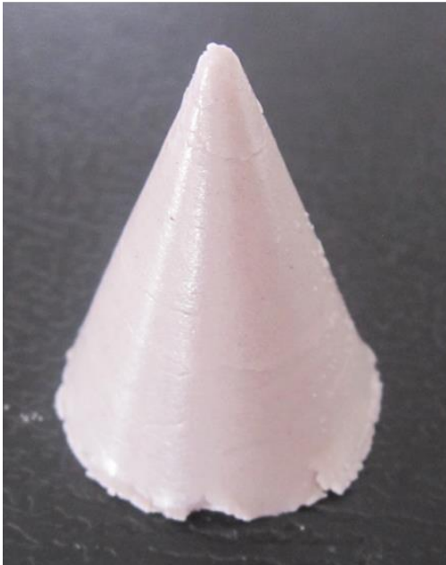
Figura 50 . Conos de fusión de feldespatos de origen Colombiano
