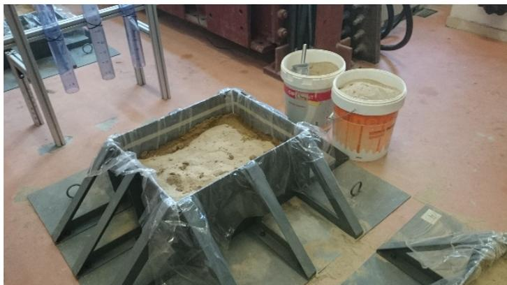
*Figura D1. 9: Instantánea durante el proceso de mezclado de arena fina bioestabilizada.*
