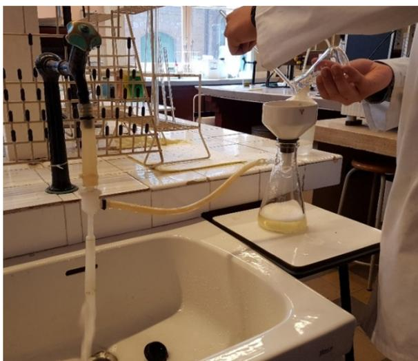
*Figura A1. 19: Proceso de filtración mediante un embudo Büchner conectado a un Kitasato y una bomba de vacío.*
