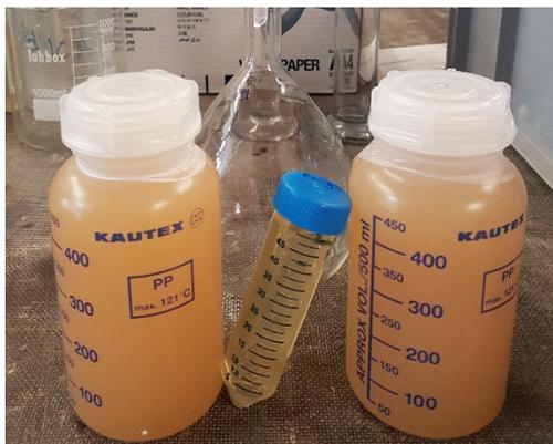
Figura A1. 12: *Sporosarcina pasteurii* (concentración  $1 \times 10^8 - 1 \times 10^9$  cfu/ml) con medio Bang.
