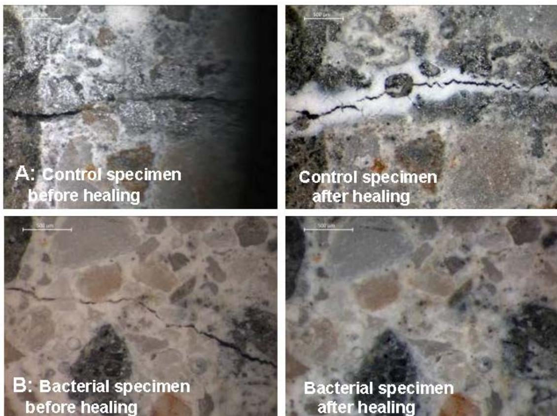
Figura 2. 14: Imágenes de microscopio de muestras tratadas con el mecanismo de auto reparación A: sin bacteria y B: con bacteria, antes y después del tratamiento [47].
