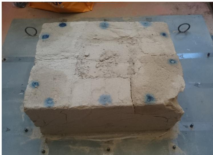
*Figura E2 6: Probeta SS control y posición de los puntos.*
