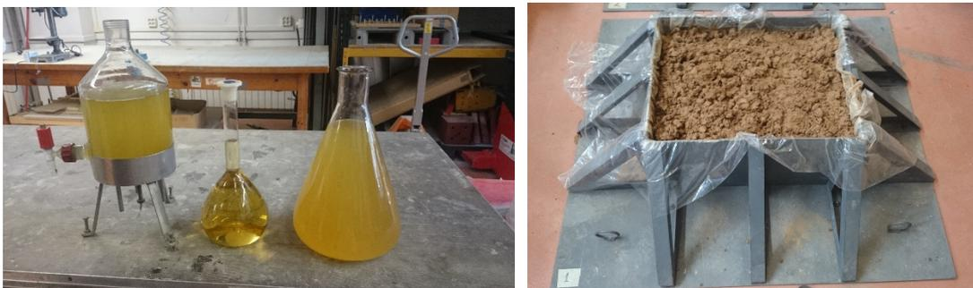
*Figura D1. 6a: Suspensión bacteriana diluida en medio Bang y el posterior riego en 4 horas; 6b: El suelo de M2 mezclado con la suspensión bacteriana diluida en medio Bang.*
