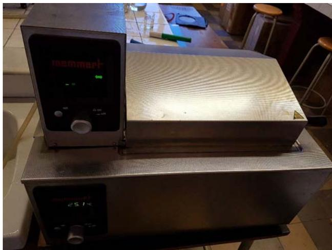
Figura A1. 18: Baño térmico con agitación utilizado.
