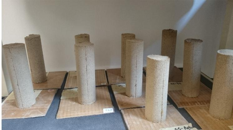
*Figura B2. 5: Las probetas desmoldadas.*
