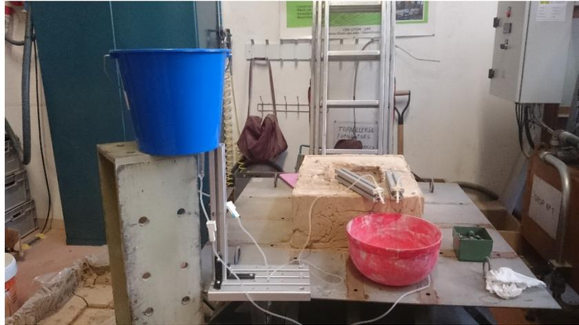
*Figura E2 1: El cubo con el agua, los goteros y la probeta desmoldada.*
