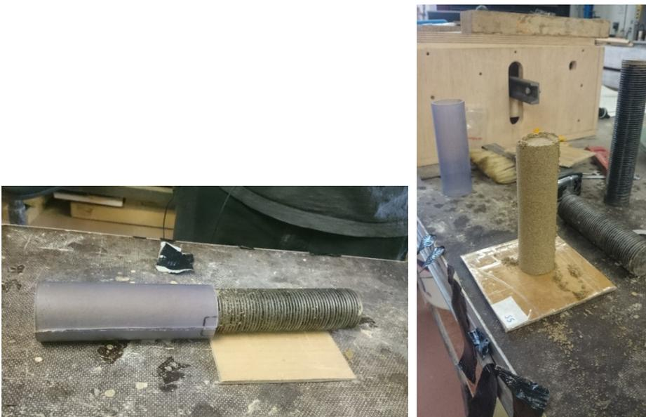
*Figura B2. 4a: La probeta dentro del cilindro cortado, situados horizontalmente. Figura B2 4b: El cilindro desmoldado.*
