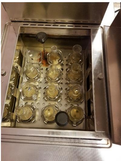
Figura A1. 17: Posición de las probetas en el baño con agitación.
