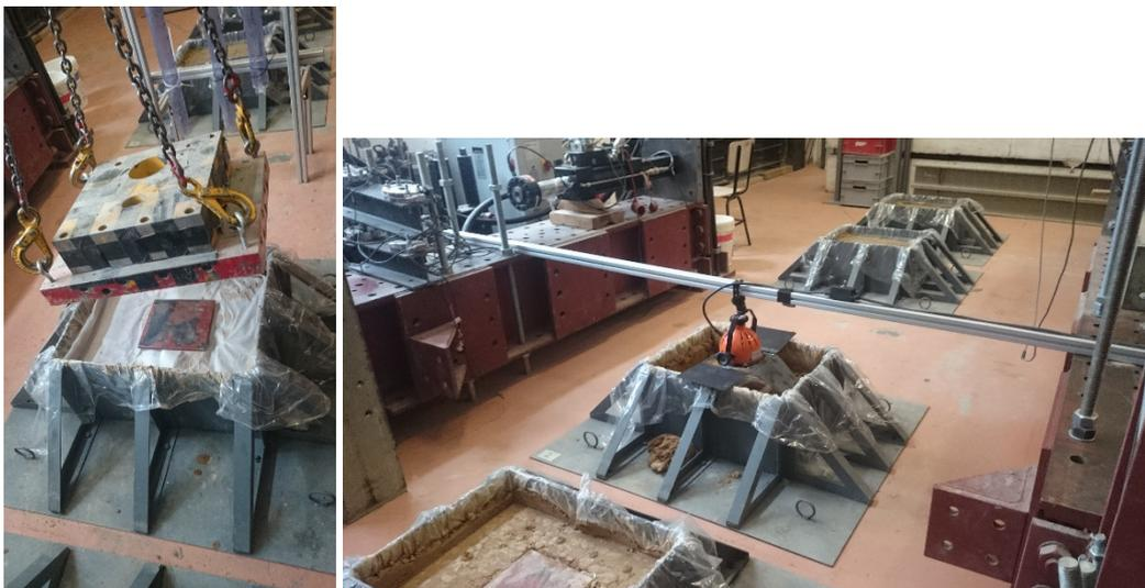
*Figura D1. 7a: Placa de compactación de los suelos M2; 7b: Foco halógeno de 500W instalado.*
