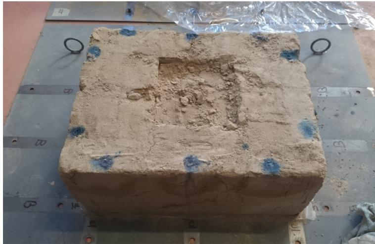
*Figura E2 5: Probeta SS bioestabilizada y posición de los puntos.*
