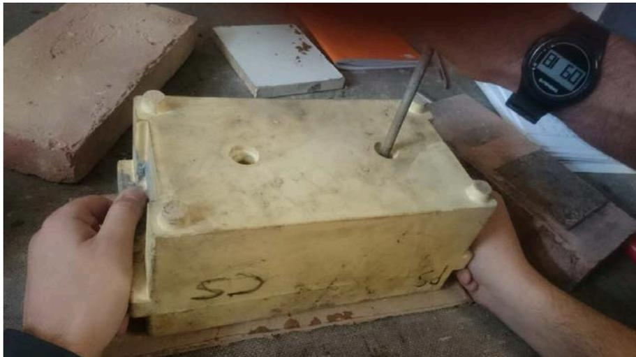
*Figura C1. 6: Instantánea durante el proceso de desmoldado de las probetas.*
