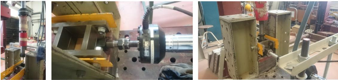
Figura C1. 7: Ensayos de corte directo con actuador horizontal y con actuador vertical
