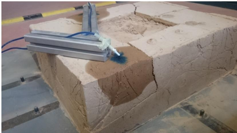
*Figura E2 2: Posición de los goteros en la probeta.*
