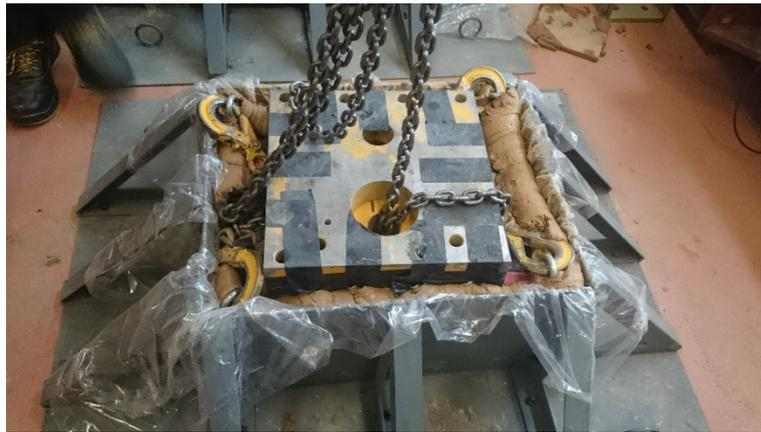
*Figura D1. 8: Placa de compactación colocada encima de M2 de control antes de la compactación.*
