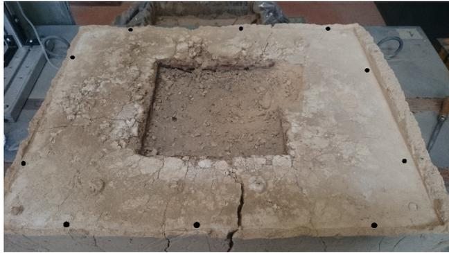
*Figura E2 3: Probeta M2 bioestabilizada y posición de los puntos.*
