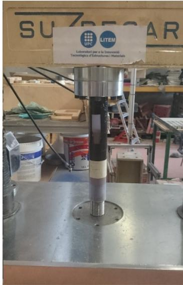
*Figura B2. 3: Instantánea durante el proceso de desmoldado de probetas en la máquina de compresión.*
