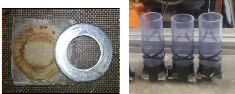
*Figura B1. 5a: Malla metálica y arandela, utilizadas en el ensayo; B1. 4b: Recipiente preparado con suelo.*
