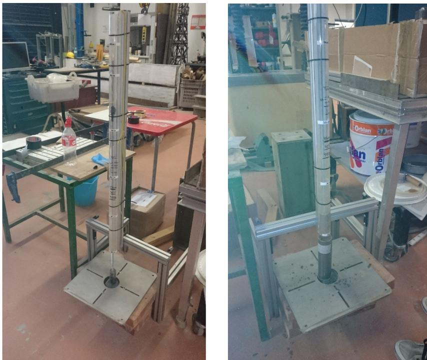
Figura B2. 1: El mecanismo utilizado para compactar las probetas en el ensayo Proctor Modificado.
