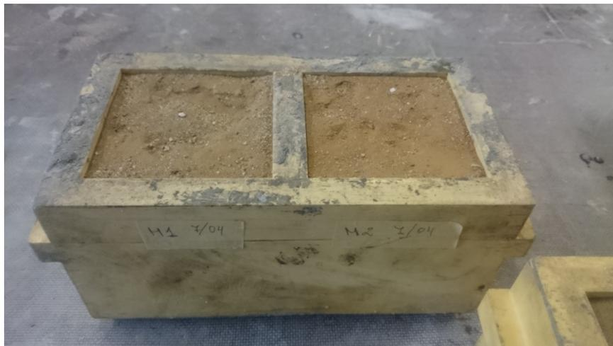
Figura C1. 5: Probetas de M1 y M2 tratadas solo con agua corriente.
