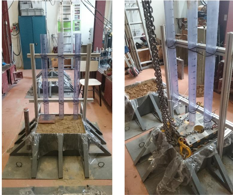
*Figura D1. 5a: Sistema para la compactación de los suelos de arena; 5b: Sistema para la compactación de los suelos de mezcla 2.*
