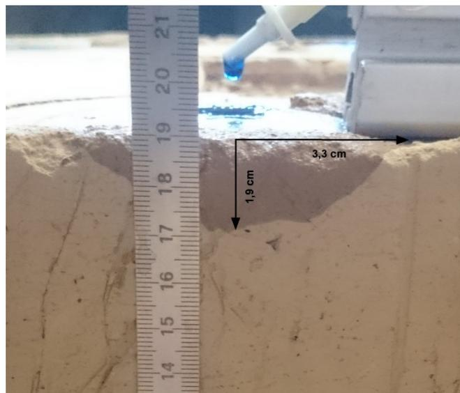
*Figura E2 7: La distancia en dirección axial y radial de la probeta M2 de control en el punto A1.*
