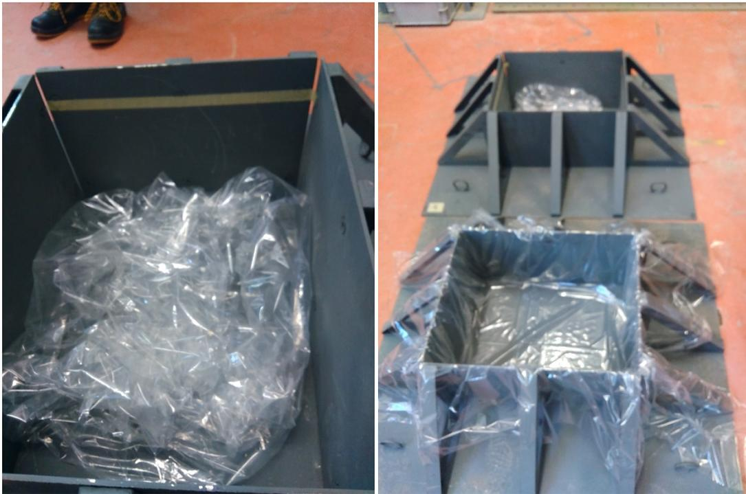
*Figura D1. 2a: Sistema del control del volumen de relleno; D1. 2b: Moldes utilizados en este ensayo.*
