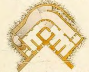
Corte de las mismas mamposterias al nivel de las cañoneras del piso superior.
