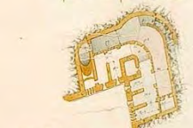
Corte de las mismas mamposterias al nivel de las cañoneras del piso superior.
