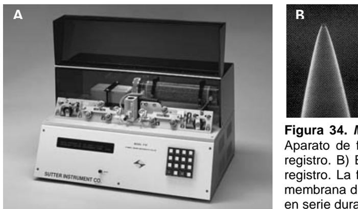
**Figura 34. *Micropipette puller* y pipeta de registro.** A) Aparato de forja horizontal para diseñar micropipetas de registro. B) Ejemplo de una punta de una micropipeta de registro. La forma es crucial para generar un sello con la membrana de la célula, romperla y mantener la resistencia en serie durante todo el registro.
