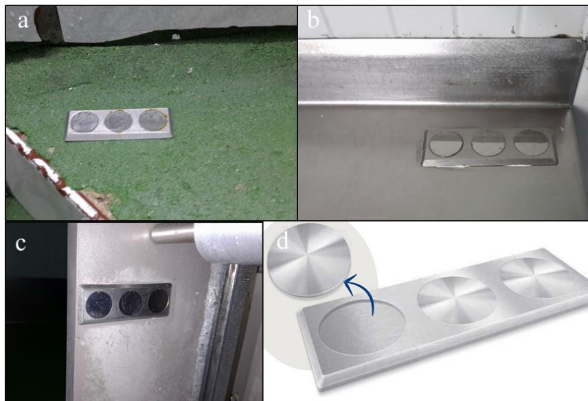
Figura 6. Base con los sensores SCH correspondientes (d) y ejemplos de su colocación en la industria colaboradora. Modificado de Ripolles-Avila (2018), siendo (a) el suelo del lavadero de los carros de fresco; (b) la mesa de loncheado; y (c) el lateral de la envasadora al vacío.
