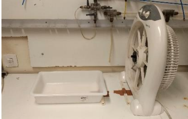
Figura 7.24. Posición de las bandejas en los ensayos de la ronda 1 con viento
