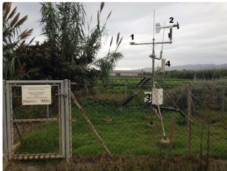
Figura 6.6. Estación meteorológica de Viladecans: (1) piranómetro para medir la radiación global, (2) anemómetro, (3) pluviómetro e (4) higrometro.
