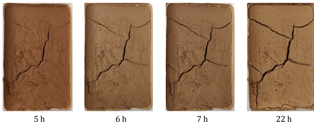
Figura 7.27. Secuencia de imágenes de la muestra WC1-2 de la ronda 1 con viento
