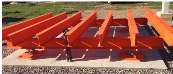
Figura 6.4. Base de la cubeta formada por losa, células de carga y perfiles metálicos
