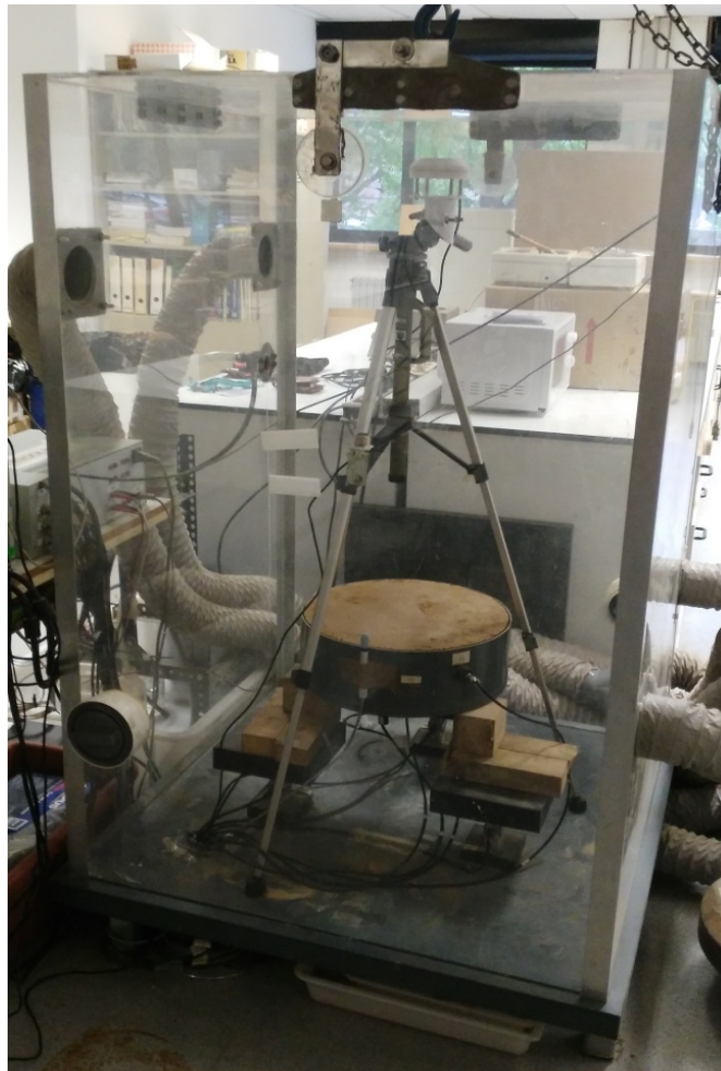
Figura 5.7. Anemómetro en el interior de la cámara ambiental para medida de viento en las condiciones del ensayo original
