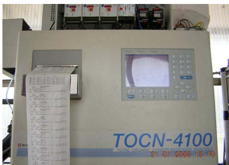
Figura 19.12: Máquina de medición en la línea de las variables TOC y TN (zoom).
