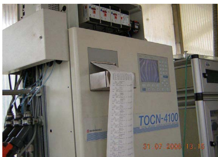
Figura 19.11: Máquina de medición en la línea de las variables TOC y TN.
