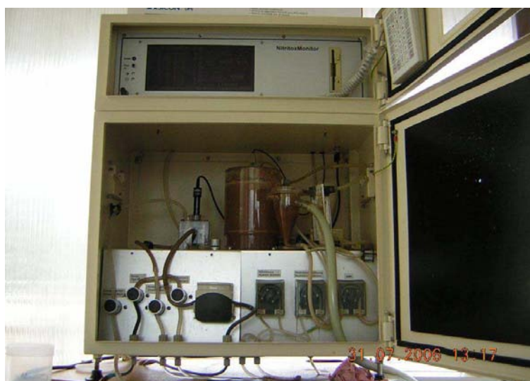
Figura 19.16: Máquina de medición en la línea de la variable influent inhibition (Nitritox).
