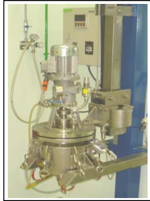
Figura 2-4. Reactor a presión y condiciones generales del tratamiento L_HBT
