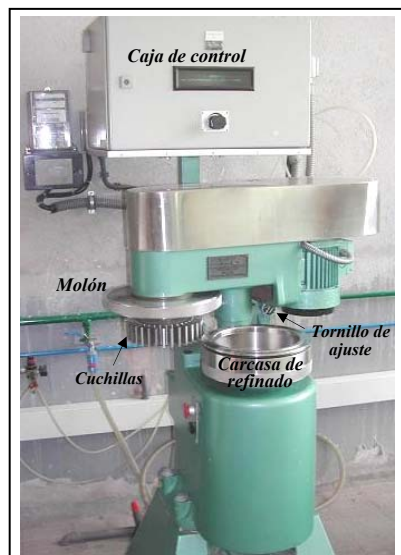
Figura 2-2. Equipo de refinado: molino PFI y condiciones de operación
