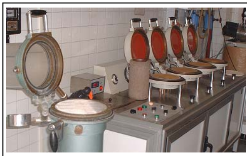
Figura 2-3. Equipo Rapid Köthen – formador de hojas de laboratorio
