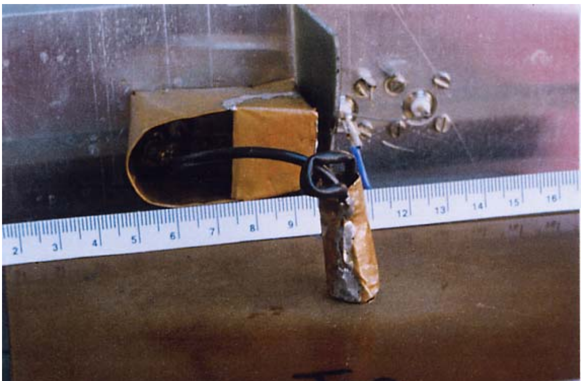
Imatge de la cèl·lula de capacitiva amb guarda. Detall de l'apantallament interior.
