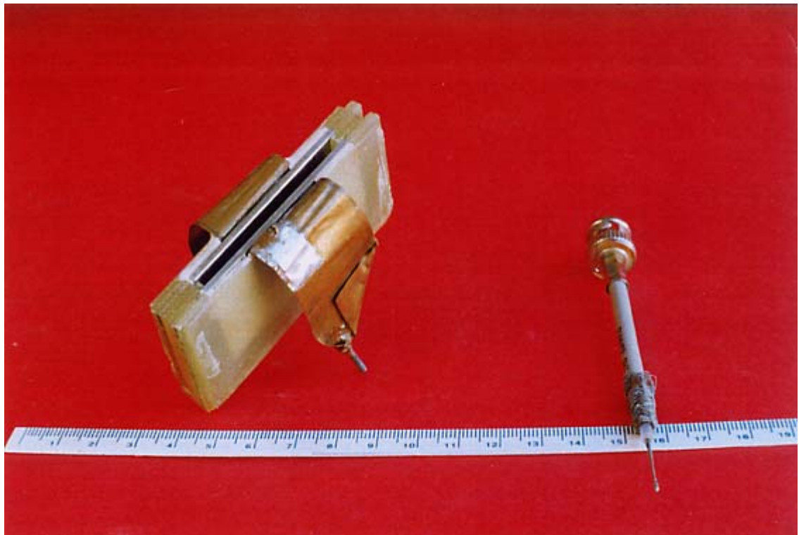
Imatge de les cèl·lules capacitiva simètrica petita (esquerra) i una cèl·lula de camp no uniforme.
