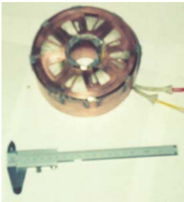
Foto 41: Plano activo n° 3. Se observan unos huecos grandes (ventanas) y otros más pequeños, que corresponden a las espiras de sombra
