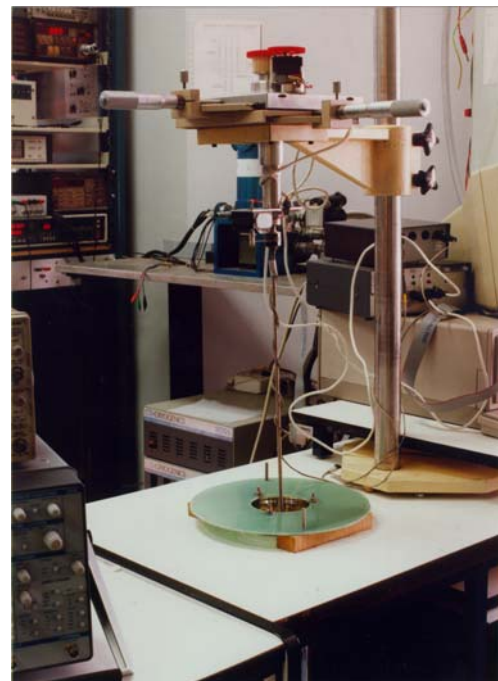
Foto 43: equipo de medición de campos magnéticos axiales. El equipo pertenece al ICMAB.
