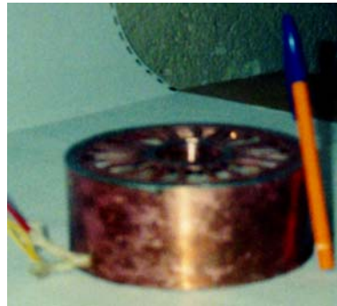
Foto 42: Transformador de corriente con la 3ª propuesta de plano activo. Se puede tener una idea relativa de su tamaño.
