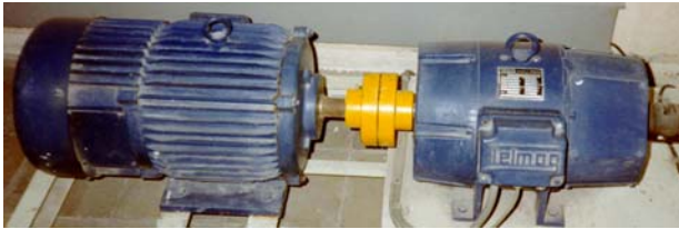
Foto 10: Grupo motor utilizado como fuente de señal eléctrica de frecuencia variable.
