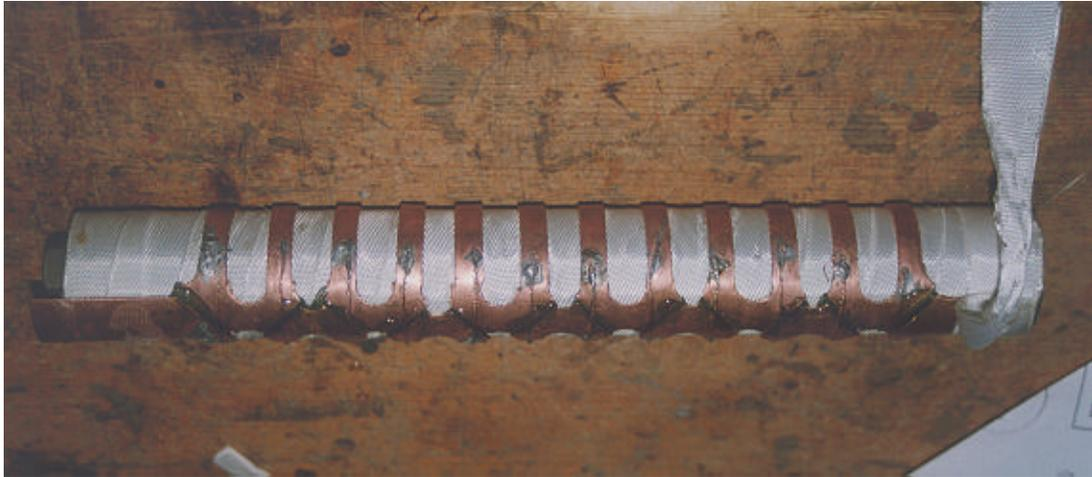
Foto. 13 : Montaje de los devanados inductores del prototipo M-2 sobre el material ferromagnético y proceso de aislamiento.
