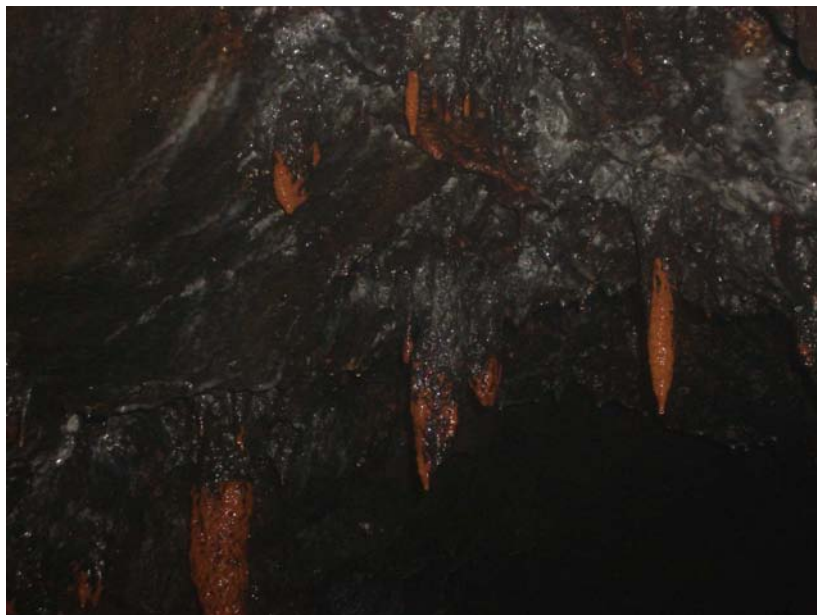
Figura 5.23. Fotografía de detalle de los precipitados de más de 10 cm en el techo de la galería Nº 5 (LGA) en la que se observaron aguas subterráneas con concentraciones relativamente elevadas de CH 4 , CO y CO 2 , y reducidas de O 2 .
