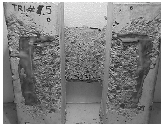
Fig. B83 Desde el lado "B" se puede ver que la lámina desgarró el hormigón del bloque central del lado "A" eficientemente.
