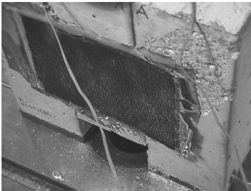
Fig. B75 El extremo derecho con respecto al lado "A" fue la zona que cedió ante los esfuerzos cortantes.
