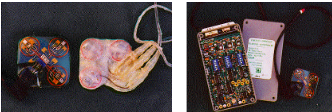
Fig. 2: Sistema Finetech Brindley para el control de la vejiga. En la fotografía de la izquierda se muestra la unidad emisora externa y la unidad receptora interna. La fotografía de la derecha muestra la unidad de control
