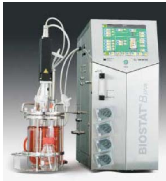
Figura 11-6: Imatge del bioreactor Biostat B plus, on es mostra la DCU integrada en un sol bloc, amb una pantalla tàctil per la consignació (a la dreta) i la cuba de fermentació amb el motor d'agitació (a l'esquerra).
