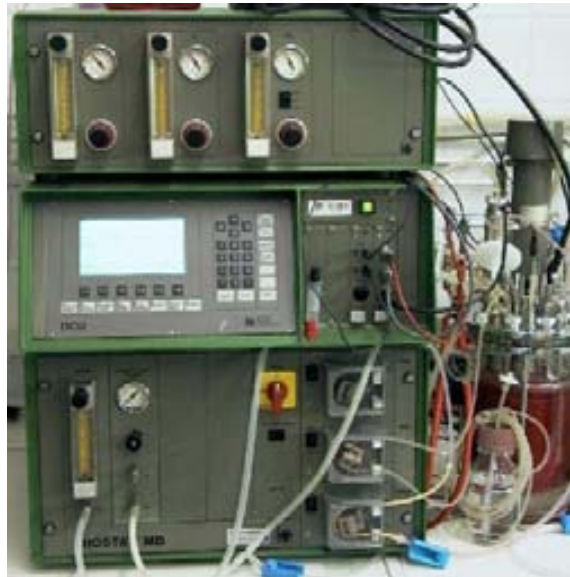
Figura 11-5: Imatge del Bioreactor MCD de Sartorius BBI Systems amb les quatre principals parts que el conformen. De dalt a baix: Estació mescla de gasos, Digital Unit Control, elements de bombeig i calefacció-refrigeració. Finalment a la dreta la cuba de fermentació.
