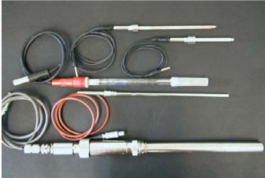
Figura 11-7: Fotografia de les sondes bàsiques associades a tots els bioreactors, de dalt a baix: Els dos primers corresponen als sensors de nivell (un per evitar acumulació d'escumes o medi, i l'altre per marcar el nivell mínim de medi), sonda de pH, sonda de temperatura i sonda d'oxigen dissolt.
