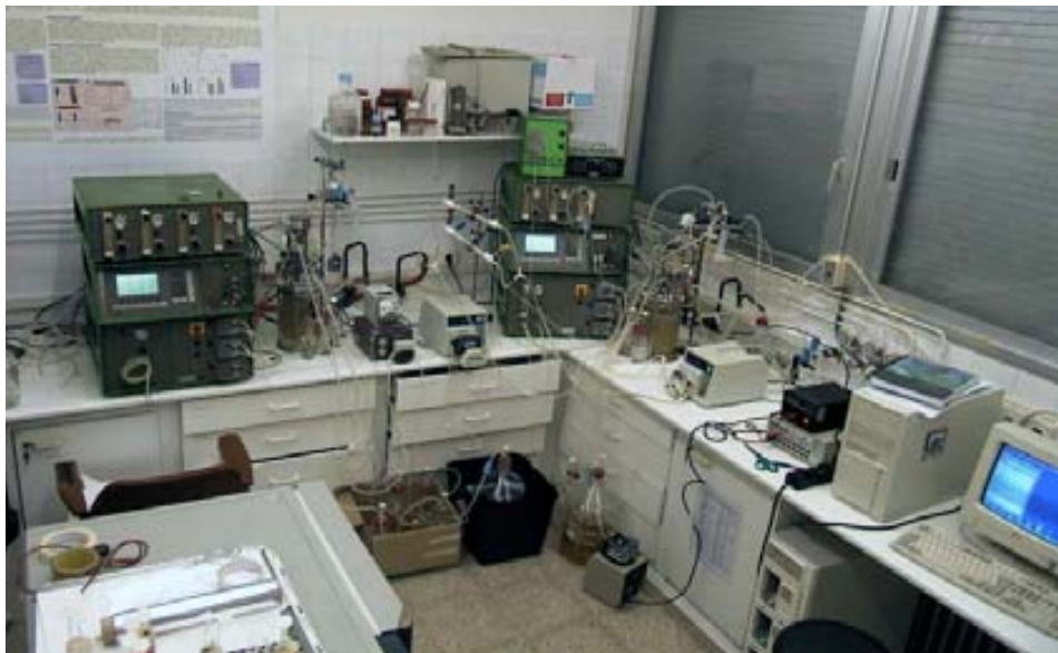
Figura 5-43: Fotografia de el cultiu en dues etapes en continu. El bioreactor de la dreta treballa en perfusió i altes densitats cel·lulars, amb la missió d'abastir de cèl·lules el bioreactor situat a l'esquerra, que treballa en continu i on es procedeix a realitzar la infecció amb el baculovirus.
