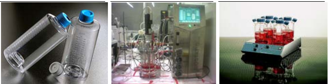
Figura 4-2: Imatges dels diferents sistemes emprats pel bioprocés per a l'obtenció de virus IBD. D' esquerra a dreta: ampolles rodants, bioreactor Braun B i flascons agitats.
