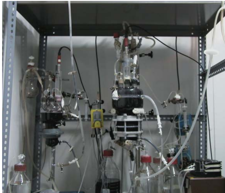
Imatge 3.1. Muntatge experimental dels bioreactors fluiditzats de 0.5 i 1.5 l de volum útil.
