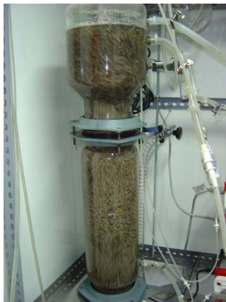
Imatge 9.3. Fotografia del reactor pilot durant el tractament d'aigües residuals reals de la indústria tèxtil.
