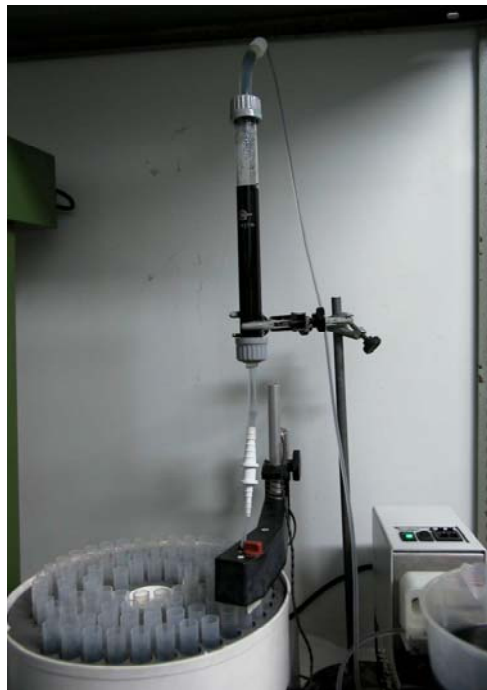
Imatge 7.1. Muntatge experimental utilitzat en els experiments d'adsorció en continu.
