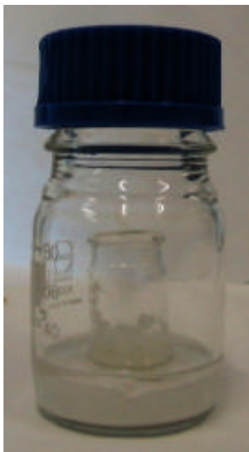
Figura ¡Error!Argumento de modificador desconocido.: Fotografia on es pot observar una preparació enzimàtica immobilitzada, equilibrant-se a una a_w=0.113 , utilitzant una solució saturada de LiCl.
