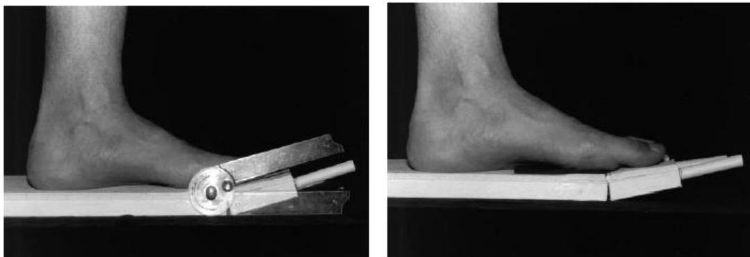
Figura 102: Goniómetro de Roukis para medir el rango de movimiento de la articulación metatarsofalángica. Foto obtenida del artículo. "Roukis TS, Scherer PR, Anderson CF; Position of the First Ray and Motion of the First Metatarsophalangeal Joint; J Am Podiatr Med Assoc 1996. 86(11)
