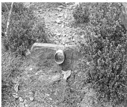
Foto 2.1: Trampa de sediments en incisió formada en un camp abandonat fa més de 50 anys
