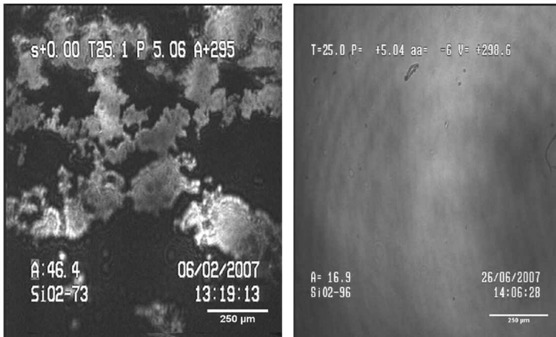
Figura 3: Imatges BAM de monocapes de partícules de \text{SiO}_2 recobertes de TMTS (esquerra) i APTS (dreta).
