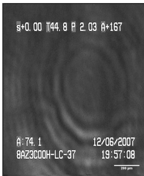
Figura 10: Imatge BAM de monocapa rica en cis a T = 45^{\circ}\text{C} .
