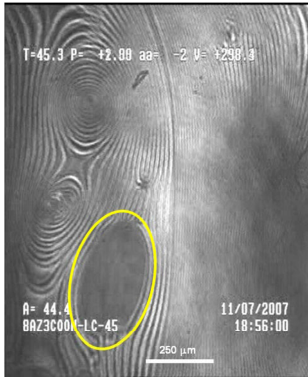
Figura 21: Imatge BAM de monocapa d'isòmer trans a T = 45^\circ\text{C} i \Pi = 2\text{mN/m} amb zona isòtropa (marcada en groc).
