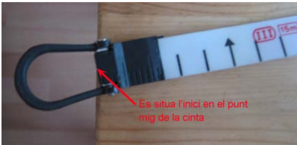
fig. 32: Detall del posicionament inicial de la cinta mètrica llarga amb la cinta inclinada. Versió 1.
