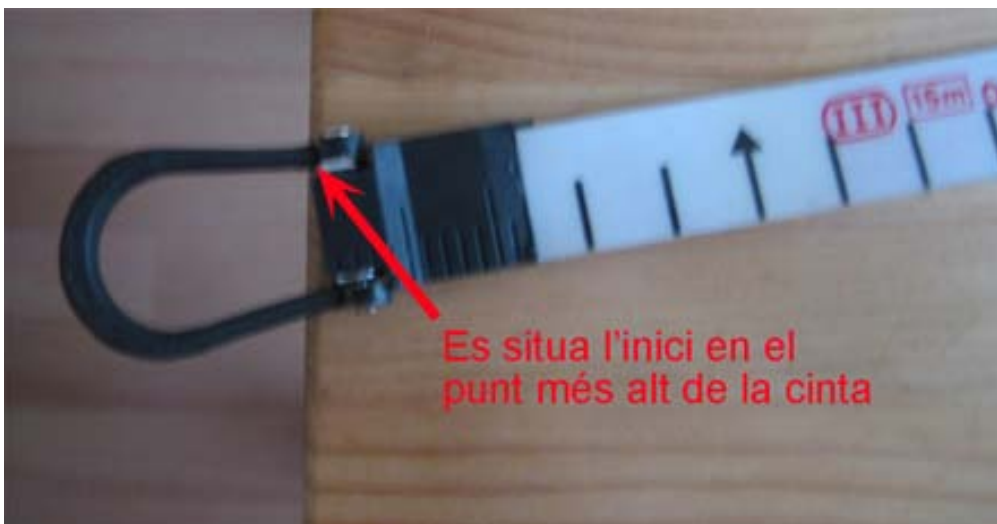
fig. 33: Detall del posicionament inicial de la cinta mètrica llarga amb la cinta inclinada. Versió 1.
